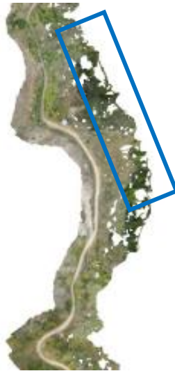
Figura N° 71: Huecos en la ortofoto generado por el traslape
