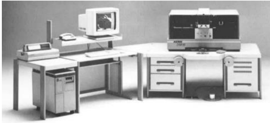
Figura N° 4: Restituidor analítico Kern DSR 15
