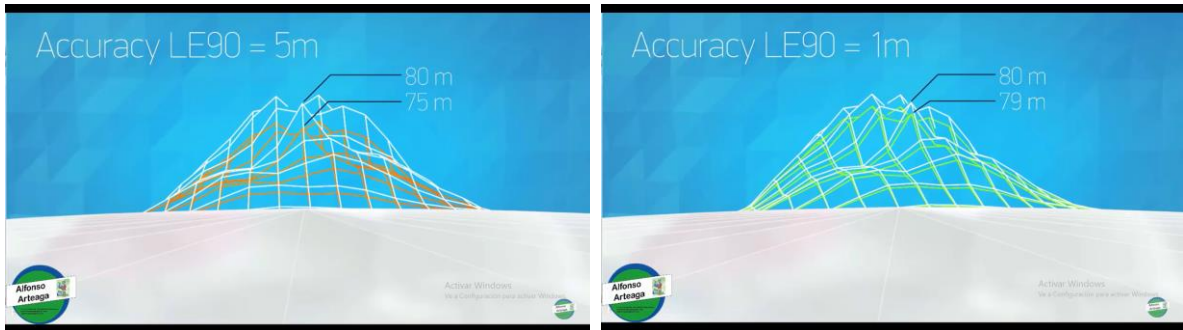
Figura N° 33: Diferencia entre la separación de los postes a 5m y 1m
