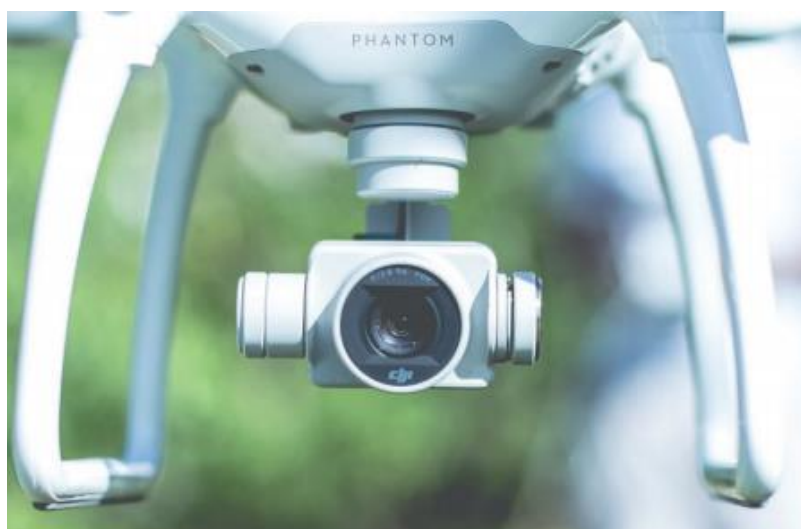
Figura N° 17: Estabilizador y cámara
