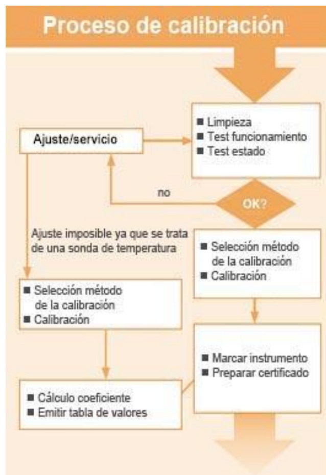
Figura N° 14. Proceso de calibración Fuente: Wika, 2020
