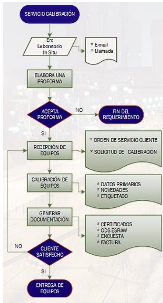
Figura N° 12. Proceso del servicio de calibración Fuente: Eswaw, 2018
