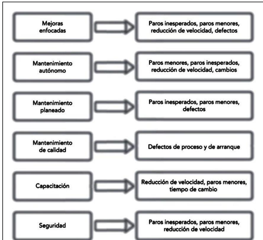
Figura 05: Los seis pilares del TPM y cómo combatir las 6 grandes pérdidas en los equipos. Fuente: (Socconini L. , 2019)
