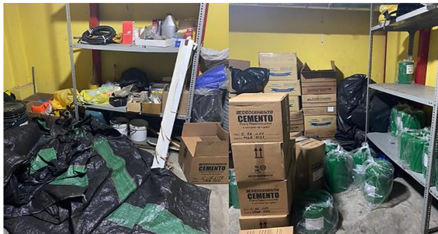
Figura 23: Desorden en el almacén de materia prima, Costales, goma cojín y cementos sin organizar y fuera de lugar antes de implementar las 5'S.
