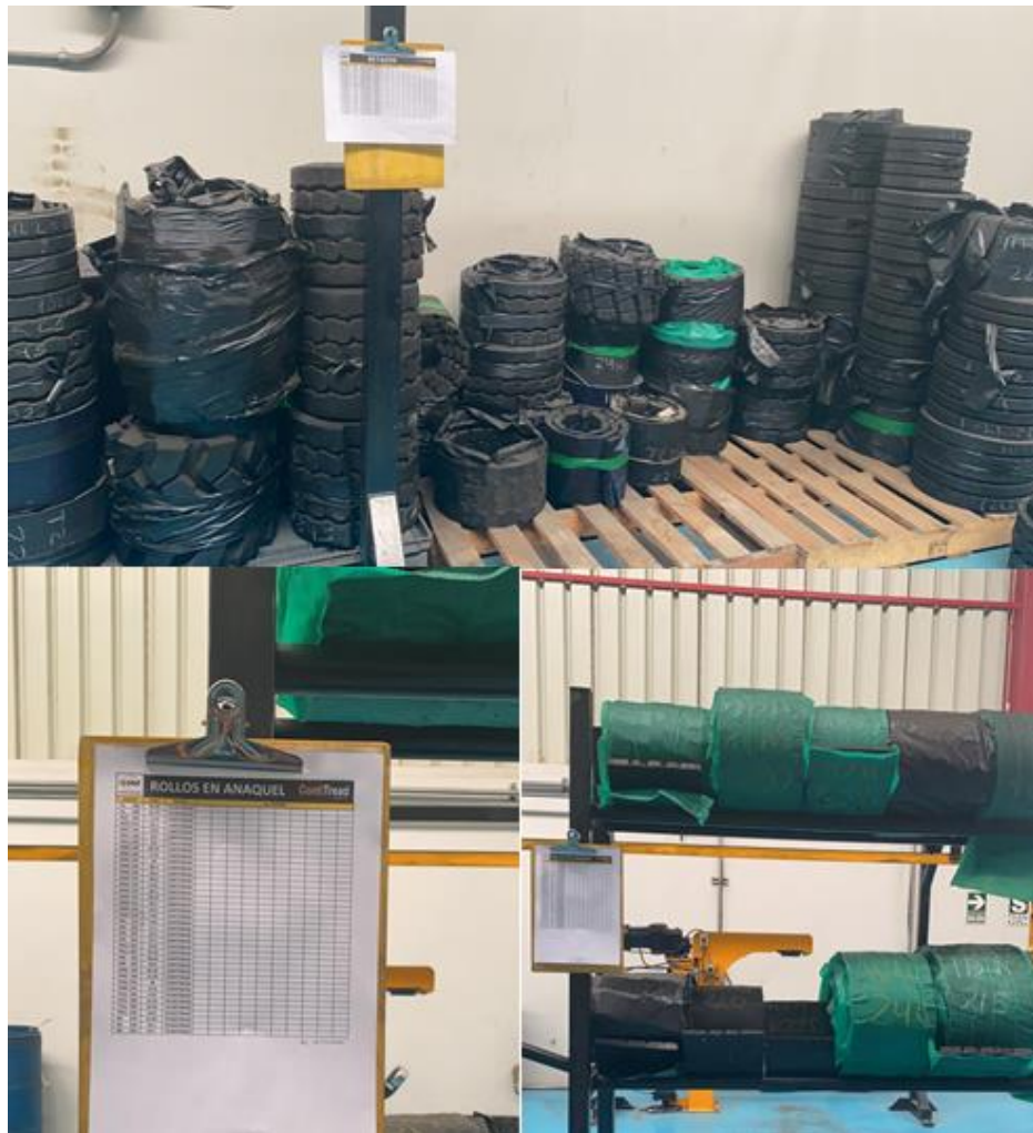
Figura 35: Organización de las bandas de rodamiento en el almacén de retazos y en el rack de corte de banda después de aplicada las 5'S.
