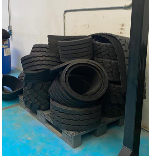
Figura 19: Desorden en área de retazos de banda, retazos no clasificados sin identificar antes de implementar las 5'S. Fuente: Datos de la empresa. Elaboración propia.
