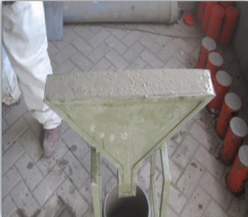
Figura N° 8: Equipo de Embudo en V.
