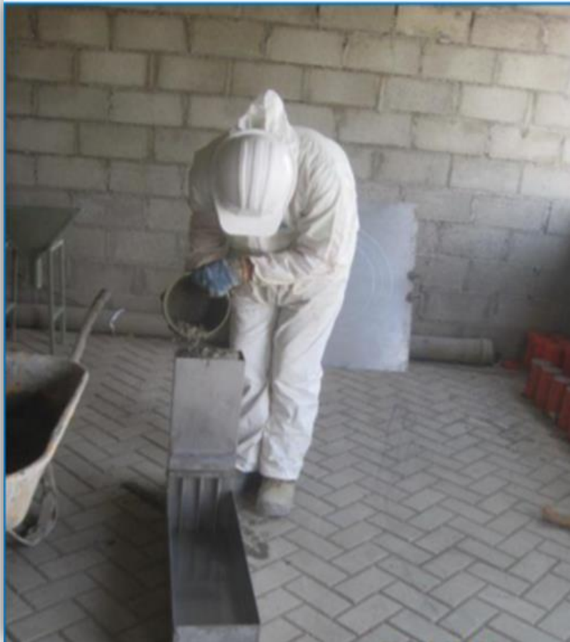
Figura N° 7: Equipo de Caja en L.
