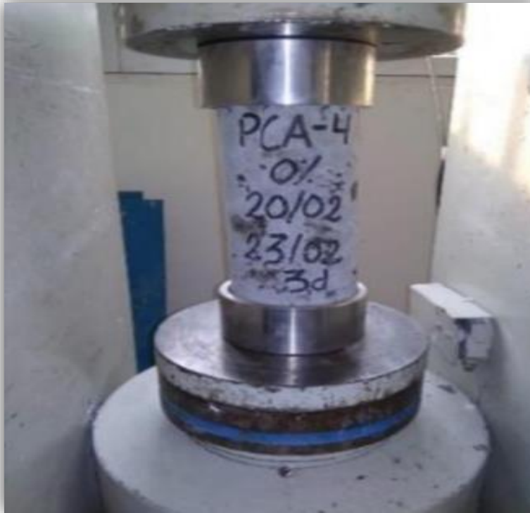
Figura N° 10: Espécimen de CAC ensayado.
