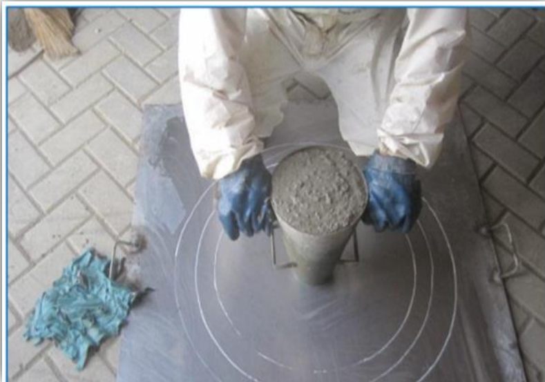
Figura N° 6: Ensayo de Extensión de Flujo.
