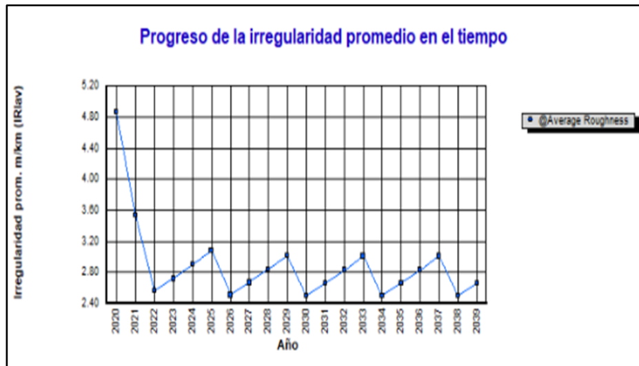
Figura N° 145: Progreso de la irregularidad promedio en el tiempo alternativa 4
