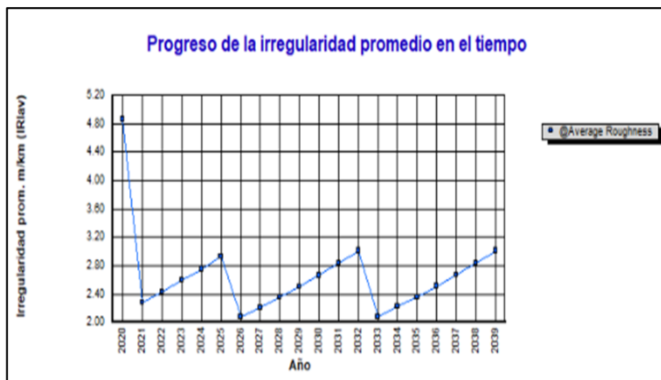
Figura N° 144: Progreso de la irregularidad promedio en el tiempo alternativa 3
