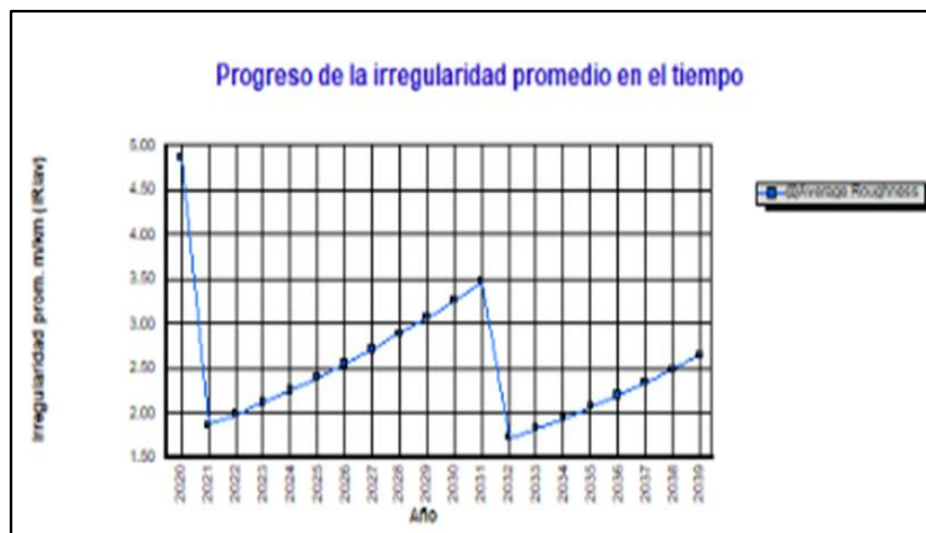
Figura N° 142: Progreso de la irregularidad promedio en el tiempo alternativa 1
