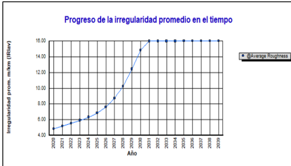
Figura N° 143: Progreso de la irregularidad promedio en el tiempo alternativa 2
