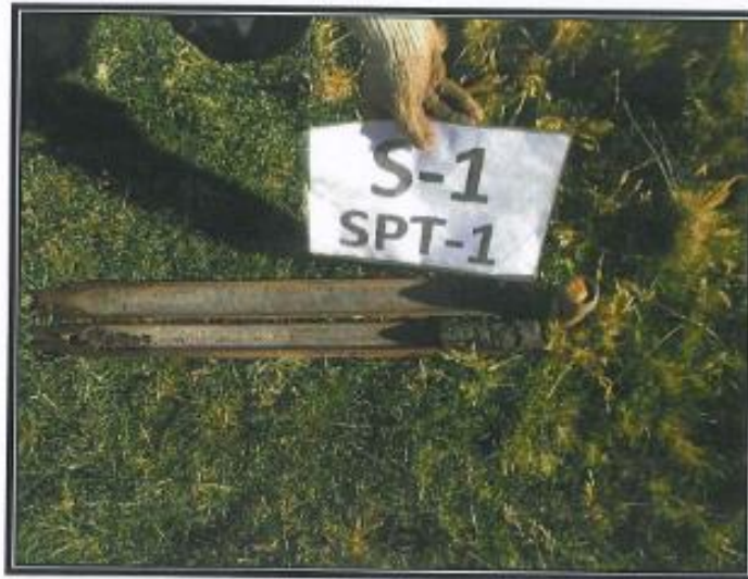
Foto N° 1 y 2: Ubicación del sondaje S-1 se presentan terreno de cultivo consistentes en arenas limosas y limos inorgánicos, de alta plasticidad, con gravas angulosas de tamaño máximo 2½", en estado semicompacto, con un número de golpes del SPT N=11-23, en un espesor de 1.00 m continuando hasta la profundidad de 2.45 m con arenas arcillosas, de mediana plasticidad, color marrón, húmeda, con gravas angulosas, de tamaño máximo de 1"- 2", en estado semicompacto; entre la profundidad de 2.45 – 3.00 m se presentan gravas angulosas con matriz arena arcillosa, de baja plasticidad, color beige, con gravas de ¾" – 1½" en un 10 – 15% y tamaño máximo 3", en estado semicompacto; luego se presenta arcillas arenosas, de mediana plasticidad, color marrón, húmeda a saturada, en estado semicompacto a compacto de acuerdo al número de golpes del SPT N=6 – 52, con un espesor de 4.00 m, continuando hasta la profundidad de 9.45 m con arenas arcillosas, de baja plasticidad, color beige, con gravas angulosas de tamaño máximo de 1"-1½" aisladas, en estado compacto, con un número de golpes del SPT N= 45 – 79, subyaciendo hasta la profundidad explorada de 12.90m con la auscultación dinámica Cono Peck el número de golpes comprendido entre Cn=37 – 53, presentando el subsuelo en estado semicompacto a compacto. Se presenta filtraciones a la profundidad de 2.90 m.
