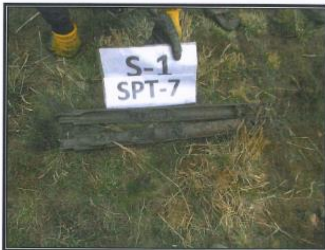
Foto N° 3 y 4: Vista del sondaje S-1, se aprecia la muestra extraída del ensayo SPT -7
