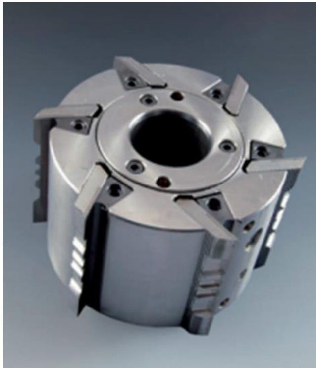
Figura 23: Cabezal porta cuchillas Z=6 (Post test) Elaboración: Propia.
