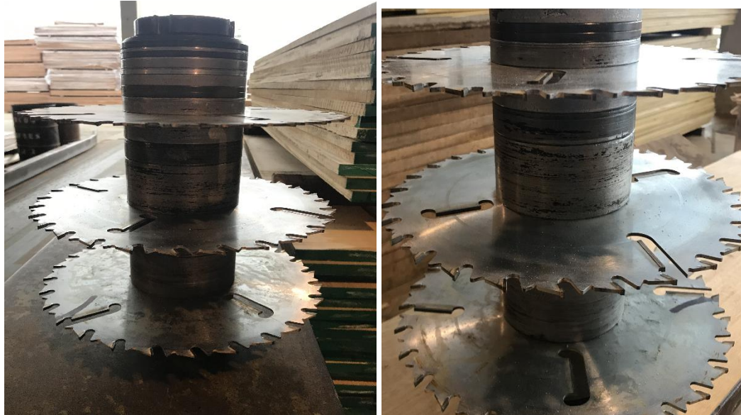
Figura 19: Espaciadores para calibración de elementos de corte (Post test) Elaboración: Propia.
