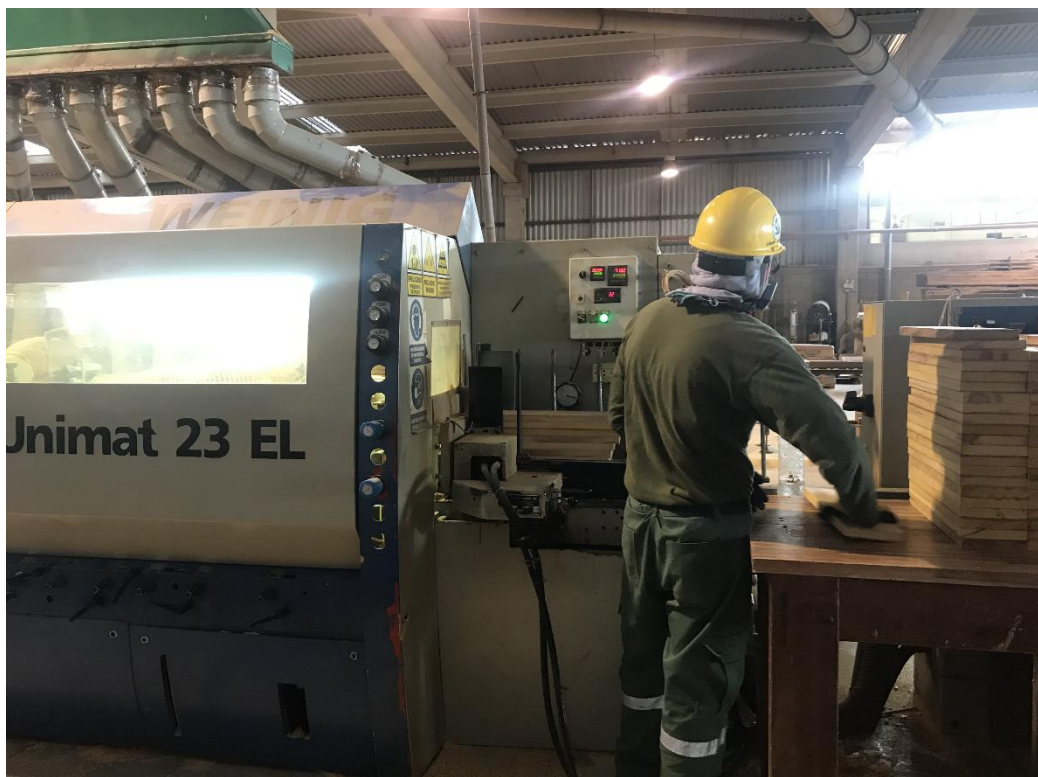
Figura 21: Alimentador automático en la maquina moldurera (Post test) Elaboración: Propia.
