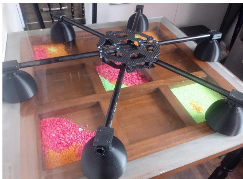
Figura 67: montaje del tren de aterrizaje.
