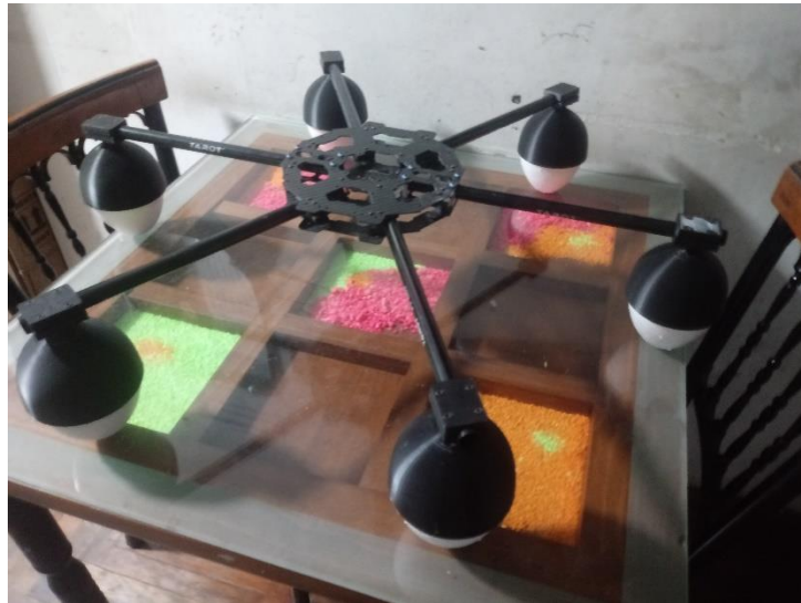
Figura 68: Tren de aterrizaje modificado Fuente: Elaboración propia.
