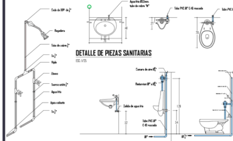
Imagen 64: Detalle de piezas de sanitarias Fuente: Elaboración propia
