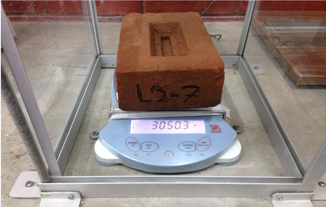
Fotografía N° 45: Pesando el espécimen de ladrillo después de pasar 24 horas sumergido. Fuente: Propia, tomada en el Laboratorio de Ensayo de Materiales, Universidad Ricardo Palma, 2019.
