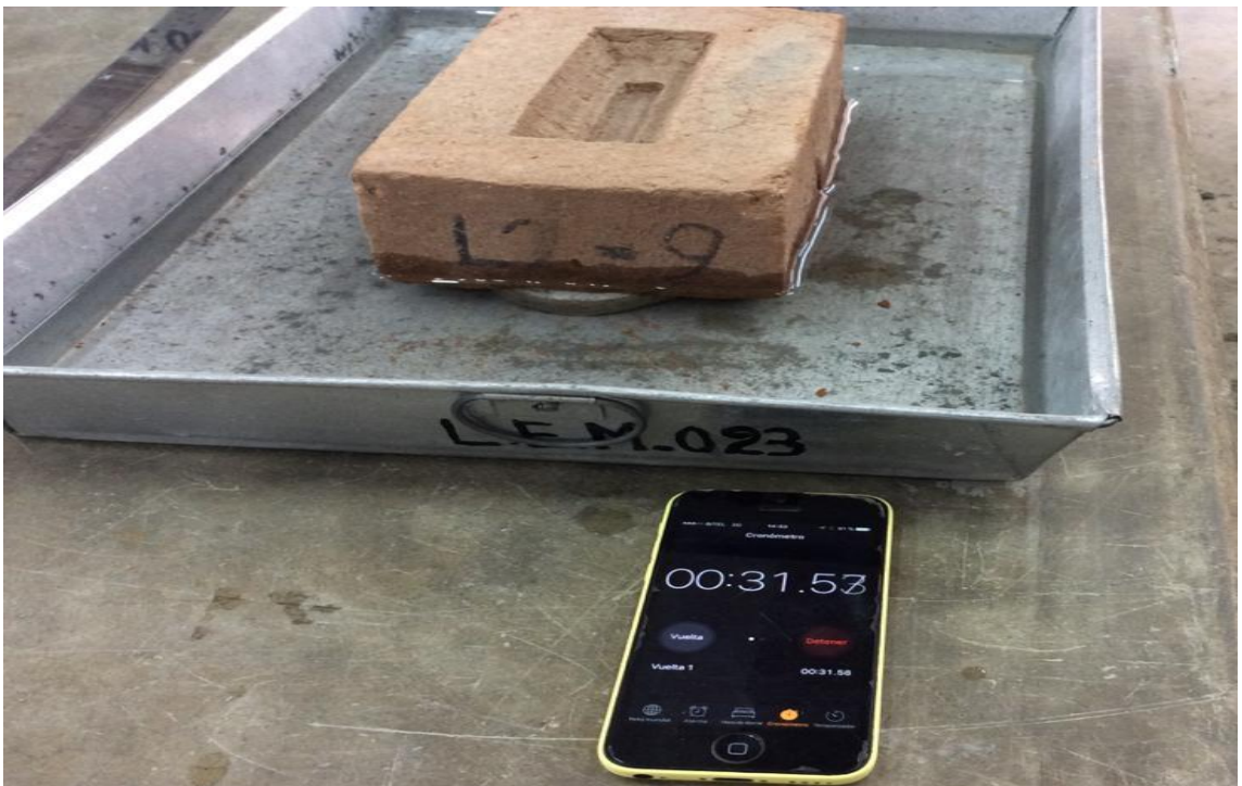
Fotografía N° 46: Calculando el tiempo durante el ensayo de succión Fuente: Propia, tomada en el Laboratorio de Ensayo de Materiales, Universidad Ricardo Palma, 2019.
