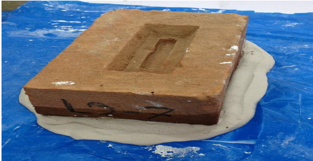
Fotografía N° 26: Colocación de la capa de yeso antes del ensayo de compresión. Fuente: Propia, tomada en el Laboratorio de Ensayo de Materiales, Universidad Ricardo Palma.
