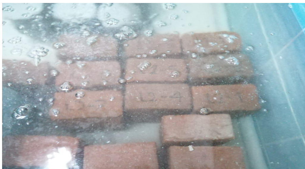
Fotografía N° 23: Sumergido de los ladrillos en el agua por 24 horas.
