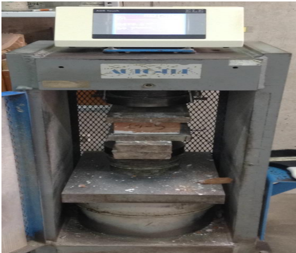
Fotografía N° 27: La máquina para hacer el ensayo de compresión. Fuente: Propia, tomada en el Laboratorio de Ensayo de Materiales, Universidad Ricardo Palma.
