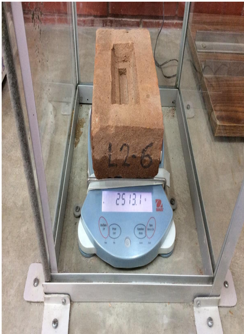
Fotografía N° 22: Pesado de los ladrillos
