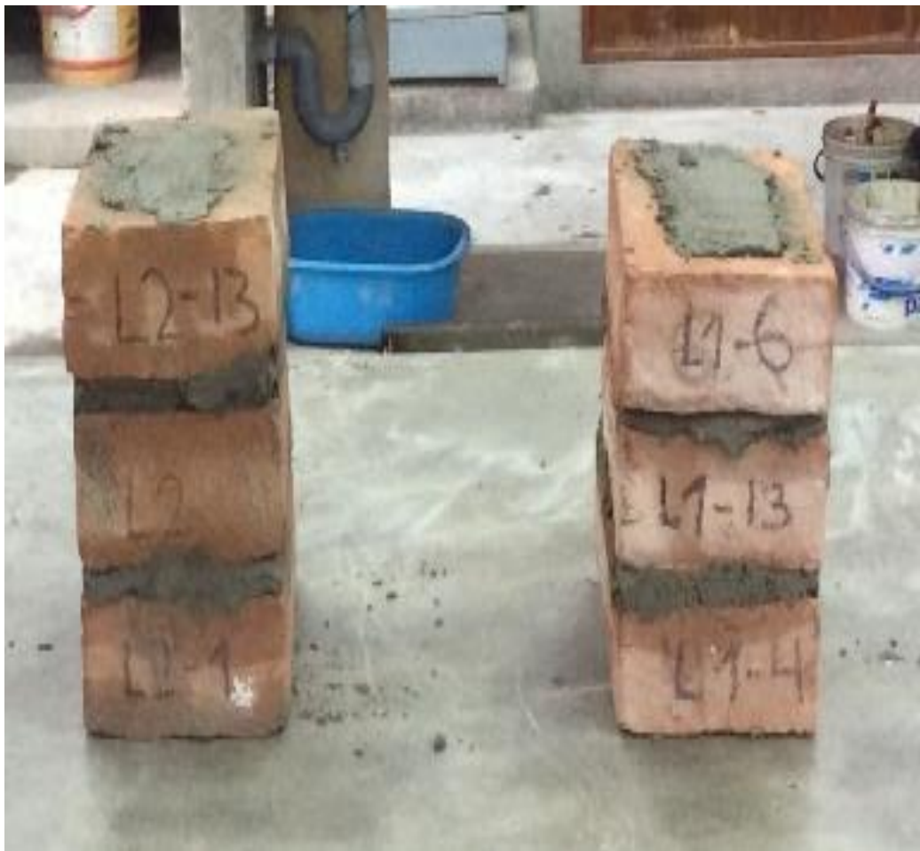
Fotografía N° 32: Ensayo a la compresión en pila de ladrillos.
