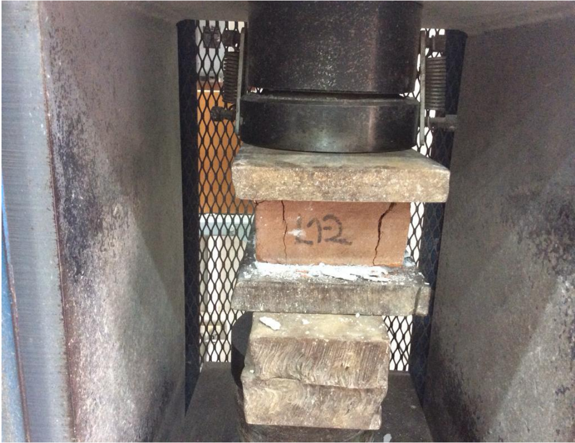
Fotografía N° 49: Ensayo de compresión de los especímenes.
