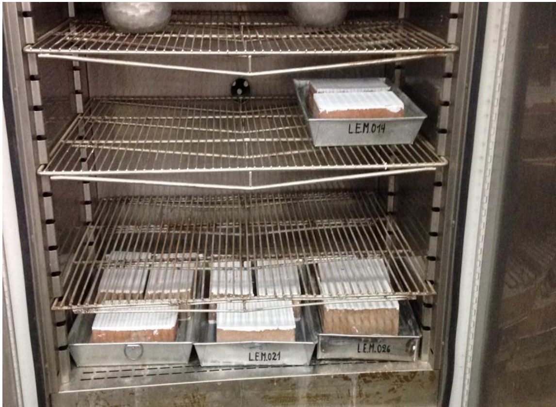
Fotografía N° 47: Secado de los especímenes previo al ensayo de compresión. Fuente: Propia, tomada en el Laboratorio de Ensayo de Materiales, Universidad Ricardo Palma, 2019.
