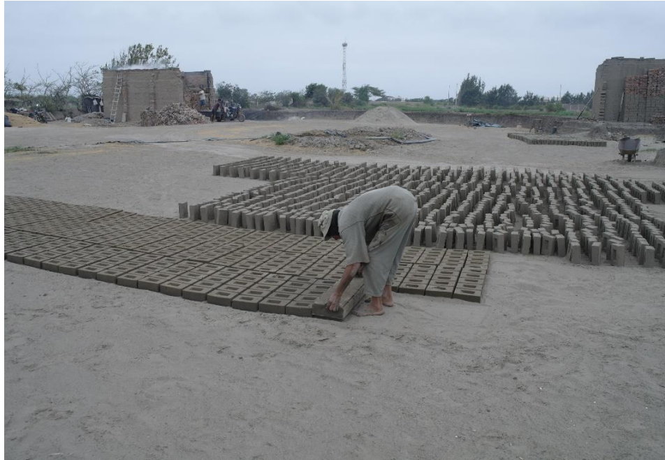
Fotografía N° 11: Secado del Ladrillo
