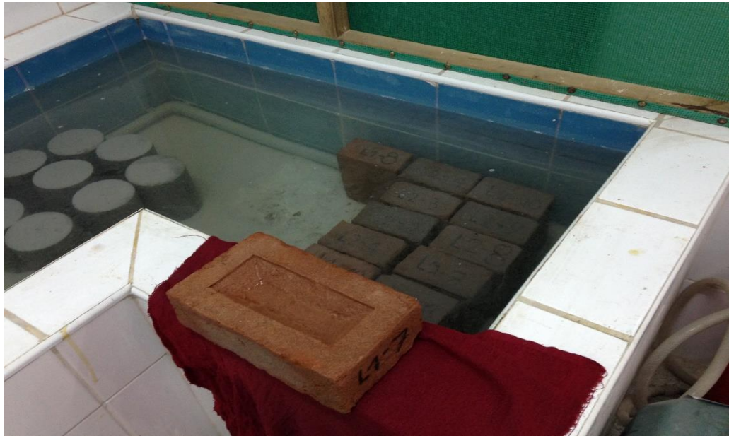
Fotografía N° 24: Retirado del ladrillo del agua para pesarlo.
