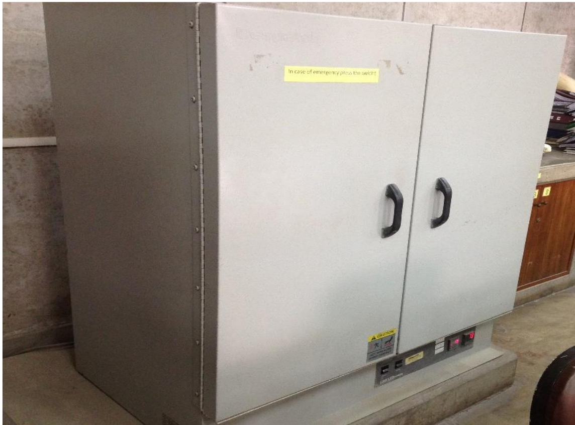
Fotografía N° 41: Horno eléctrico usado para el secado de los especímenes. Fuente: Propia, tomada en el Laboratorio de Ensayo de Materiales, Universidad Ricardo Palma, 2019.
