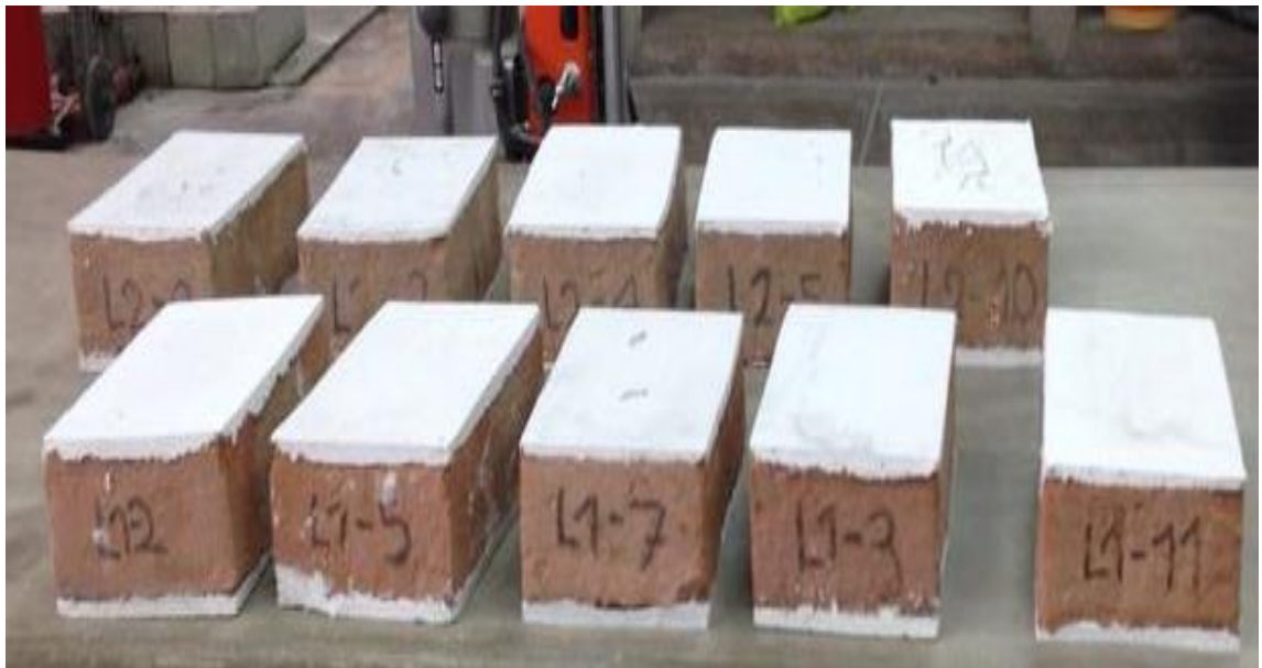
Fotografía N° 48: Especímenes listos para el ensayo de compresión. Fuente: Propia, tomada en el Laboratorio de Ensayo de Materiales, Universidad Ricardo Palma, 2019.
