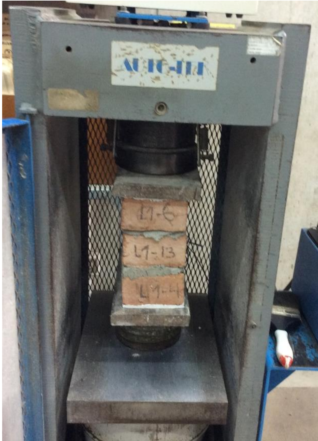
Fotografía N° 33: Ensayo a la compresión en pila de ladrillos.
