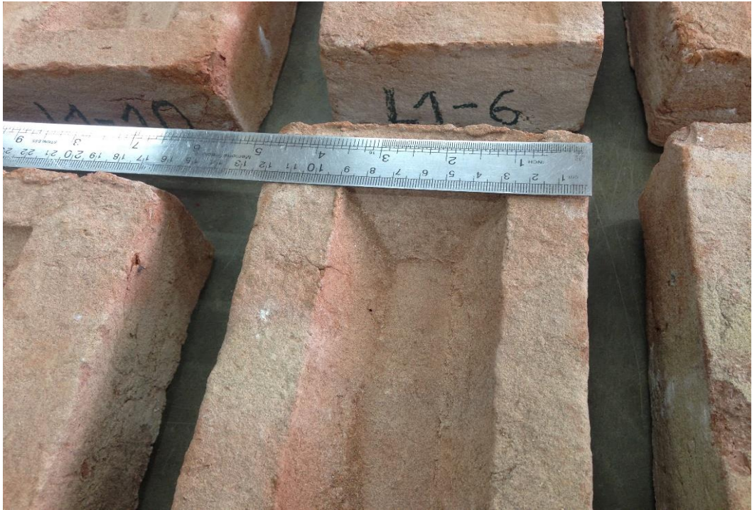
Fotografía N° 20: Medidas para el cálculo de la Variación Dimensional
