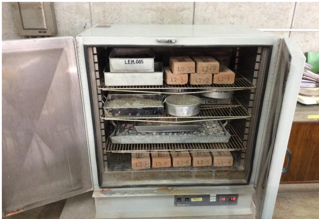
Fotografía N° 25: Colocación de los ladrillos en el horno
