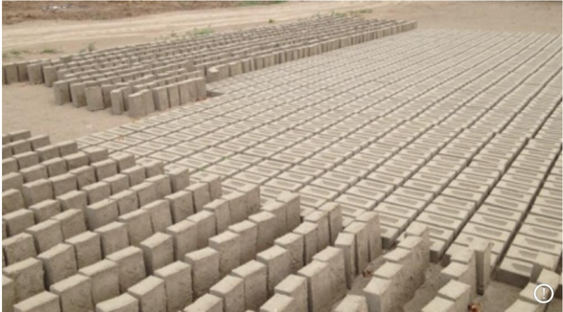
Fotografía N° 37: Secado del ladrillo, previo a la entrada al horno.
