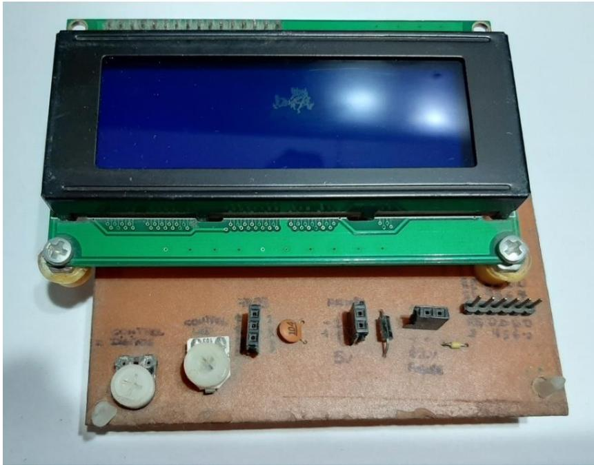
Figura N° 67: Placa implementada con LCD de 20x4
