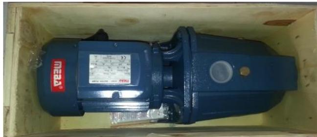
Figura N° 39: Electrobomba seleccionada
