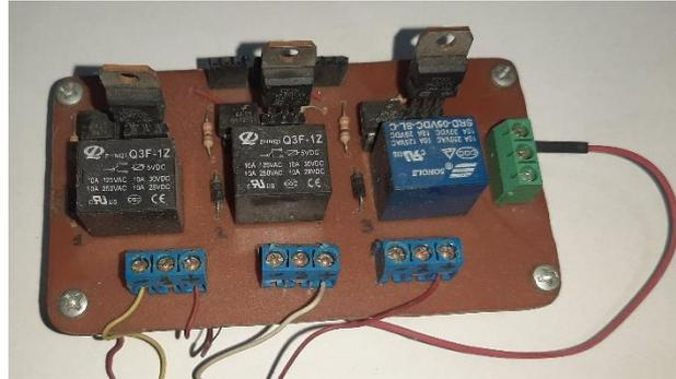
Figura N° 65: Implementación de Placa Electrónica para Electroválvulas
