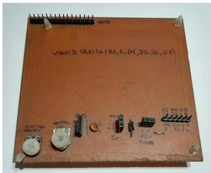
Figura N° 66: Implementación de Placa Electrónica para LCD
