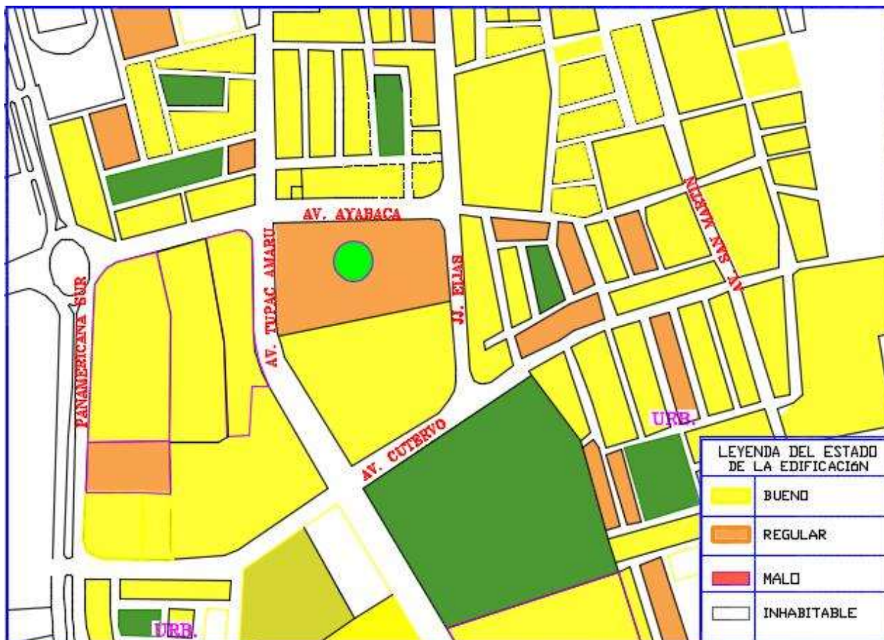
FIGURA N°20: Plano de estado de la edificación
