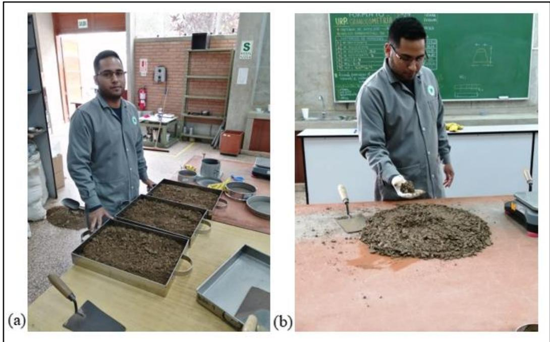
Figura 43: (a) Tamizado y dividido en 3 muestras (b) Modificación de humedad muestral
