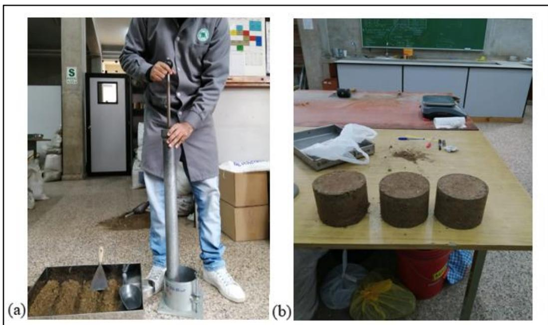
Figura 44: (a) Compactación 5 capas de 56 golpes (b) 3 muestras luego de compactación
