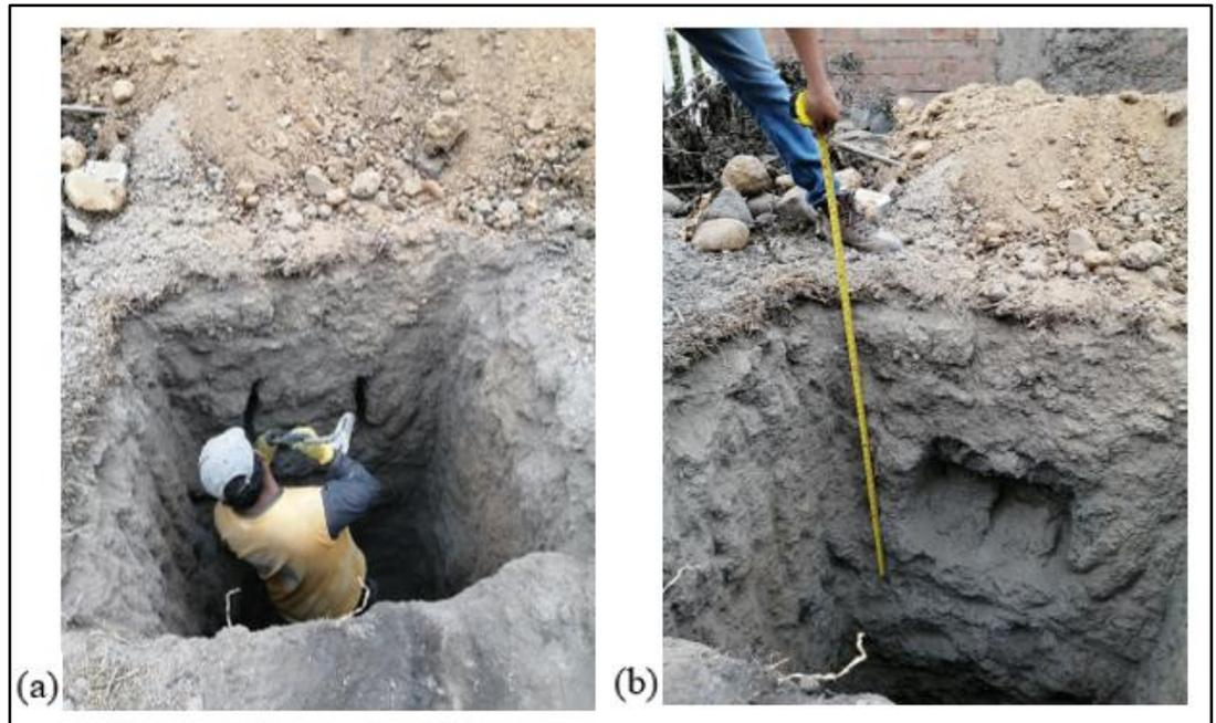
Figura 25: (a) Extracción Mib M-1 (b) Primer estrato 1.20 m de longitud.
