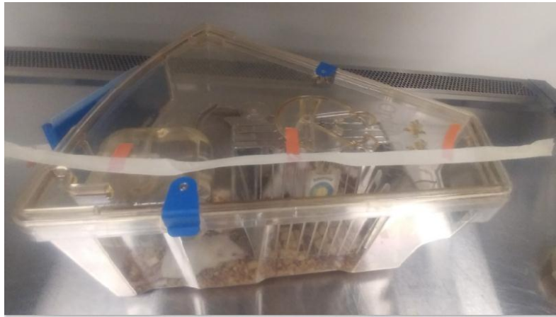
Figura 6. Ubicando 3 tiras Hydrion Ammonia al inicio, medio y final de la jaula
