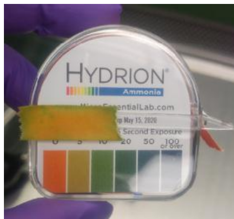
Figura 7. Realizando una lectura de las tiras expuestas al amoniaco en la jaula de ratones
