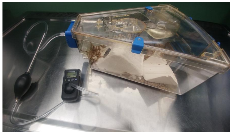
Figura 4. Jaula Optimice conectada al Kit GasAlert Extreme Ammonia
