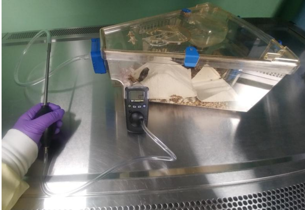
Figura 5. Lectura del amoniaco en jaula con el Kit GasAlert Extreme Ammonia
