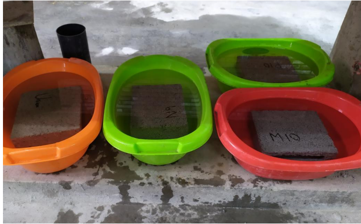
Figura 21: Saturación de bloques de concreto
