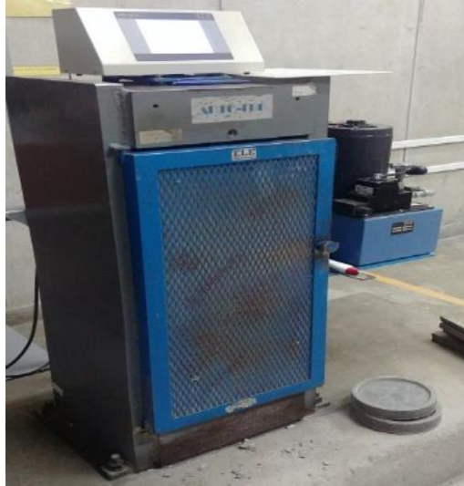
Figura 7: Máquina de compresión axial electro-hidráulica digital Fuente: Elaboración propia
