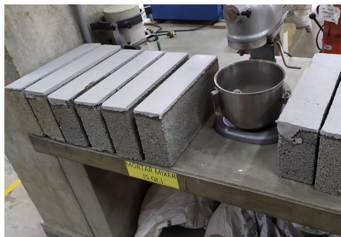
Figura 12: Capeo de bloques de concreto
