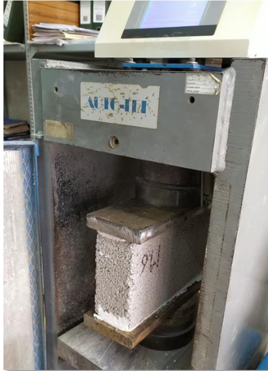
Figura 13: Ensayo de compresión de bloques de concreto Fuente: Elaboración propia
