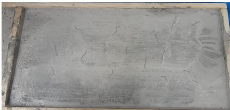
Figura 30: Fisuras Losa 03 muestra patrón (M1)  $f'c$  210 kg/ cm<sup>2</sup>
