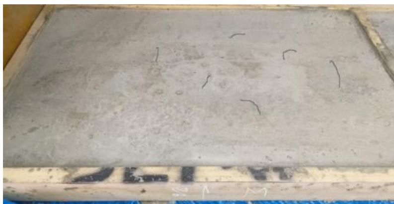
Figura 38: Fisuras Losa 02 muestra con 1% de vidrio marrón molido (M4)  $f'c$  210 kg/cm<sup>2</sup>
