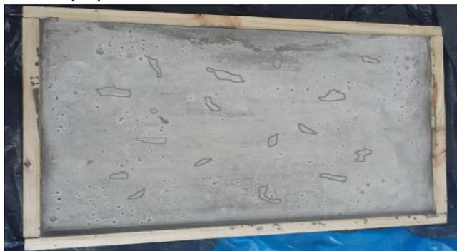
Figura 28: Fisuras Losa 01 muestra patrón (M1)  $f'c$  210 kg/ cm<sup>2</sup>
