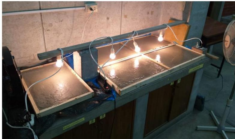
Figura 27: 5 Losas en estado de fraguado sometido a la temperatura y viento
