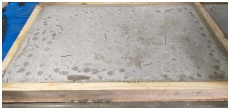
Figura 34: Fisuras Losa 01 muestra con 5% de vidrio verde molido (M3)  $f'c$  210 kg/cm<sup>2</sup>
