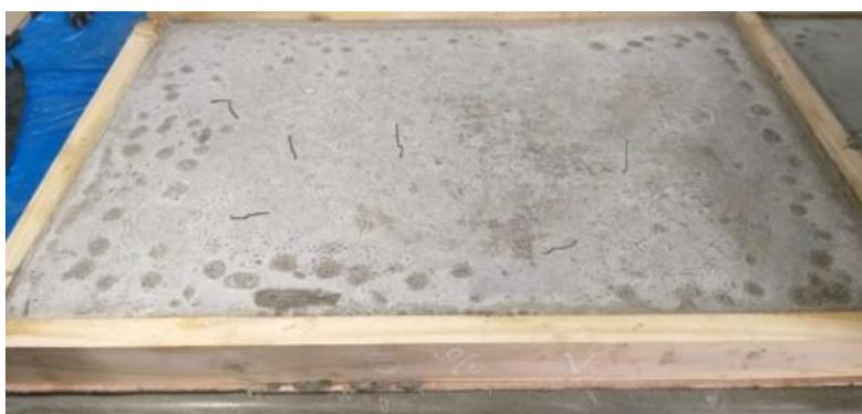
Figura 36: Fisuras Losa 03 muestra con 5% de vidrio verde molido (M3)  $f'c$  210 kg/cm<sup>2</sup>
