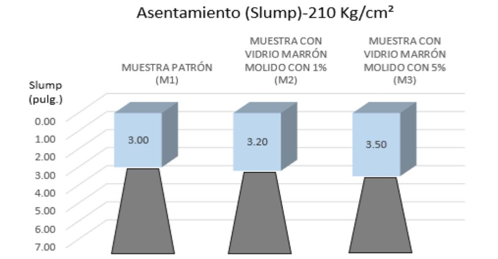
Figura 5: Gráfico comparativo de asentamiento de las muestras para f'c210 kg/ cm<sup>2</sup>
