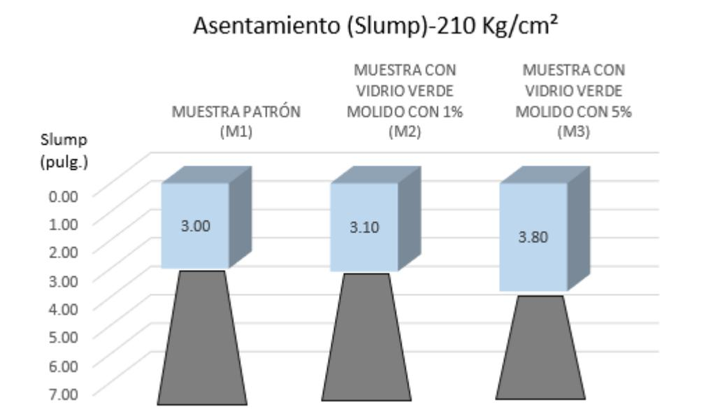
Figura 4: Grafico comparativo de asentamiento de las muestras para f'c 210 kg/cm<sup>2</sup>
