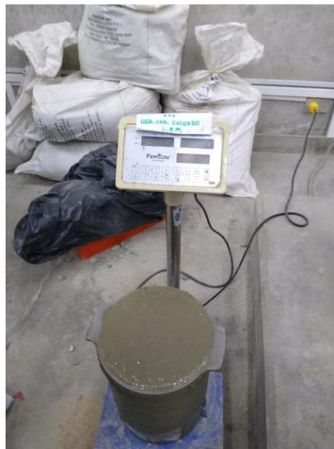
Figura 6: Cálculo de Peso Unitario del concreto
