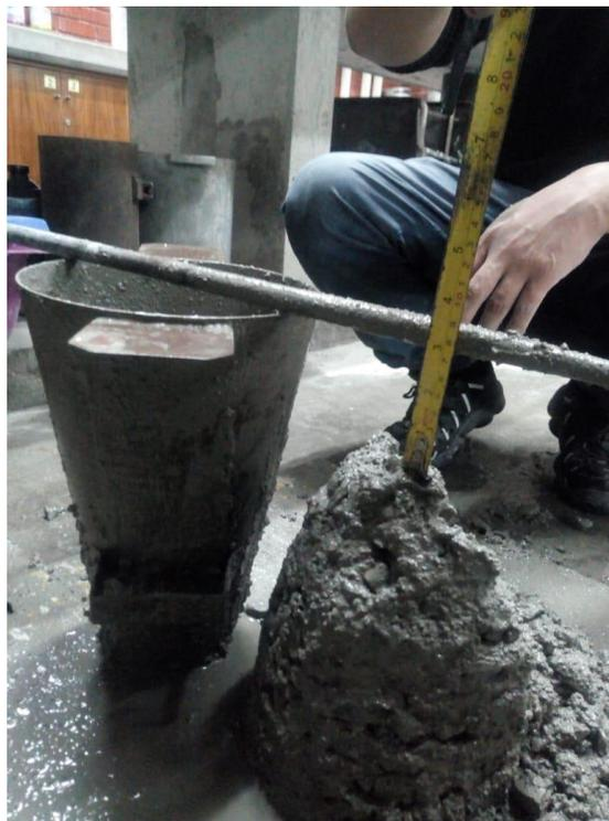
Figura 3: Medición del slump en el laboratorio de ensayo de materiales
