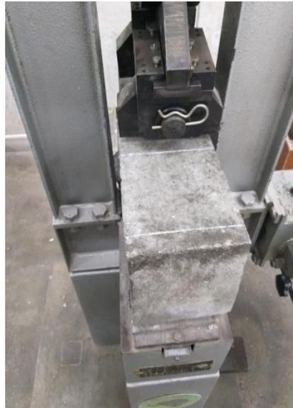
Figura 19: Ensayo de vigas a flexión en el laboratorio de ensayo de materiales.
