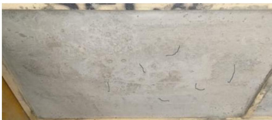
Figura 39: Fisuras Losa 03 muestra con 1% de vidrio marrón molido (M4)  $f'c$  210 kg/cm<sup>2</sup>
