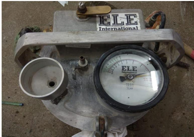
Figura 9: Medición del Contenido de Aire (%)
