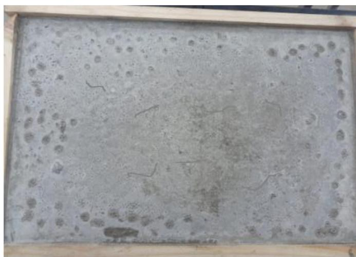
Figura 31: Fisuras Losa 01 muestra con 1% de vidrio verde molido (M2)  $f'c$  210 kg/cm<sup>2</sup>
