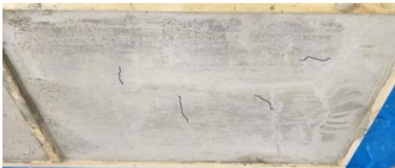
Figura 41: Fisuras Losa 02 muestra con 5% de vidrio marrón molido (M5)  $f'c$  210 kg/cm<sup>2</sup>
