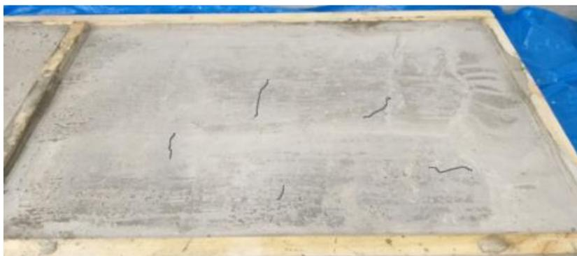
Figura 42: Fisuras Losa 03 muestra con 5% de vidrio marrón molido (M5)  $f'c$  210 kg/cm<sup>2</sup>
