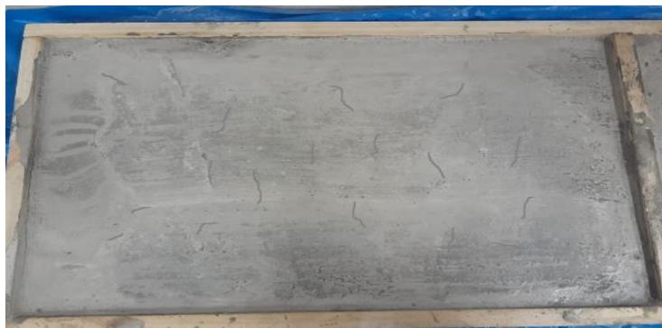
Figura 29: Fisuras Losa 02 muestra patrón (M1)  $f'c$  210 kg/ cm<sup>2</sup>
