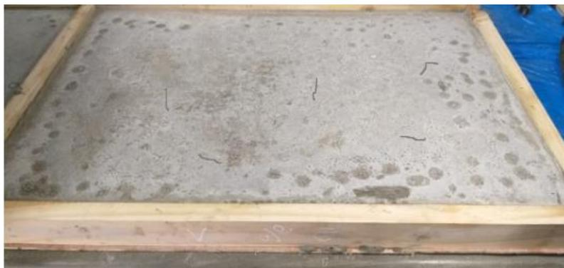
Figura 35: Fisuras Losa 02 muestra con 5% de vidrio verde molido (M3)  $f'c$  210 kg/cm<sup>2</sup>
