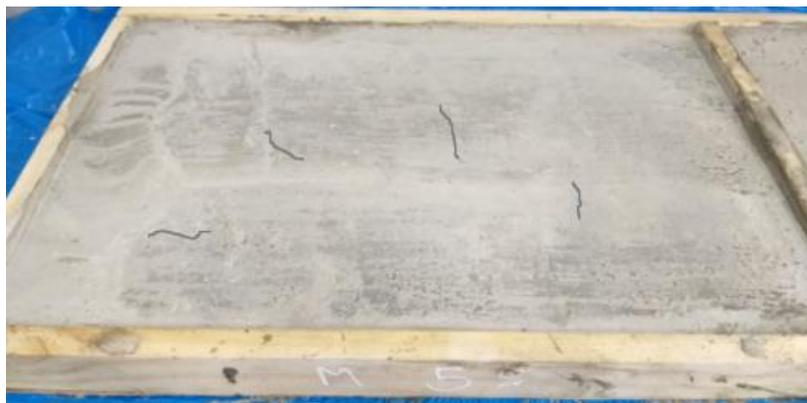
Figura 40: Fisuras Losa 01 muestra con 5% de vidrio marrón molido (M5)  $f'c$  210 kg/cm<sup>2</sup>
