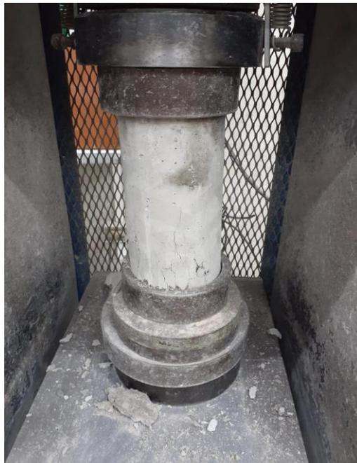
Figura 12: Ensayo de probetas a compresión en el laboratorio de concreto
