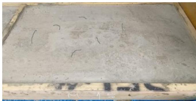
Figura 37: Fisuras Losa 01 muestra con 1% de vidrio marrón molido (M4)  $f'c$  210 kg/cm<sup>2</sup>
