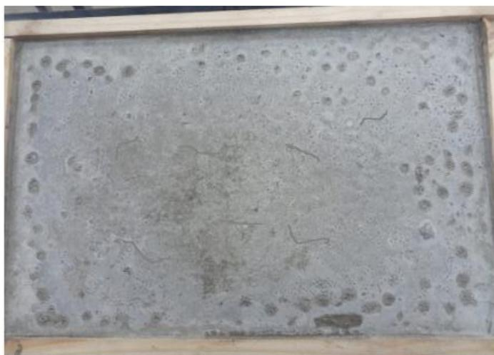
Figura 32: Fisuras Losa 02 muestra con 1% de vidrio verde molido (M2)  $f'c$  210 kg/cm<sup>2</sup>
