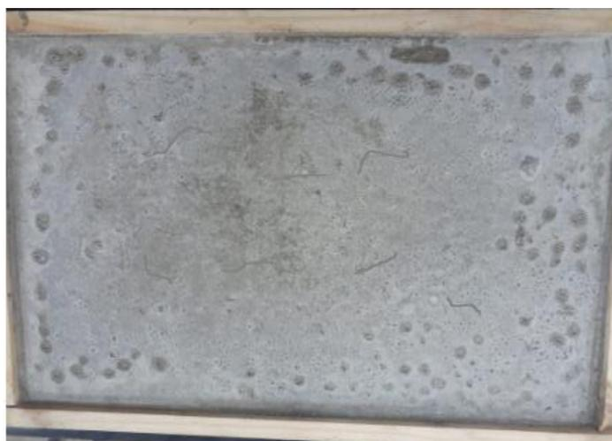
Figura 33: Fisuras Losa 03 muestra con 1% de vidrio verde molido (M2)  $f'c$  210 kg/cm<sup>2</sup>
