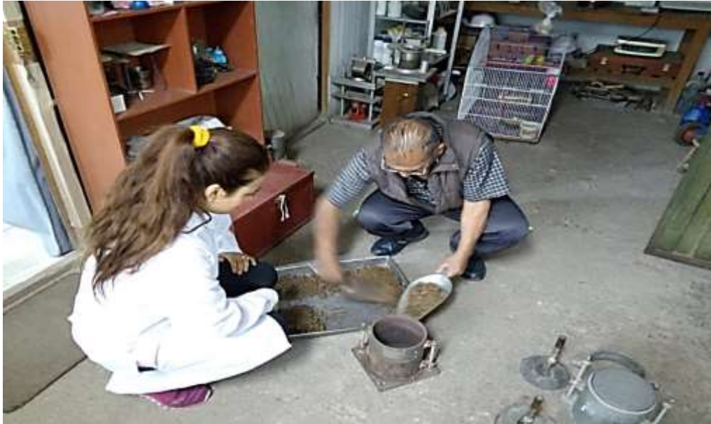
Figura N° 55: Ejecución del ensayo CBR por MNS Geotécnica E.I.R.L.
