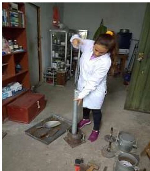
Figura N° 58: Ejecución del ensayo Proctor Modificado por MNS Geotécnica E.I.R.L.
