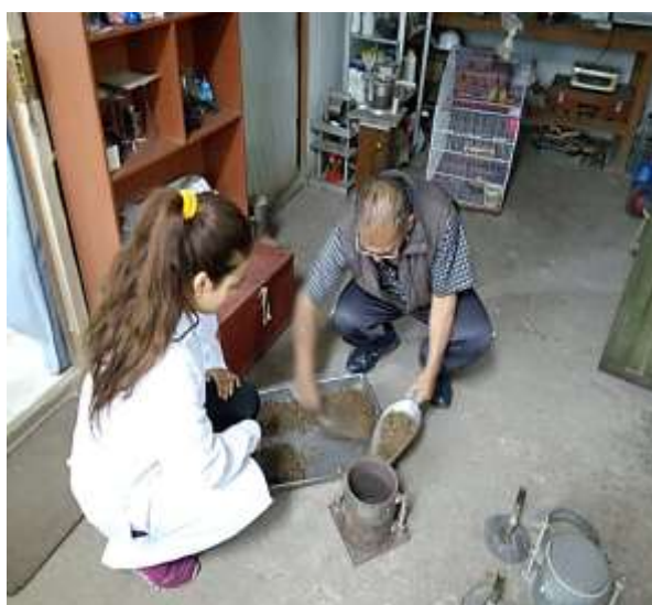
Figura N° 58: Ejecución del ensayo Proctor Modificado por MNS Geotécnica E.I.R.L.
