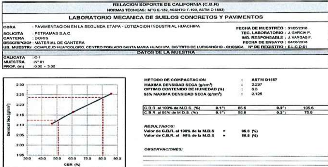
Figura N° 26: Ensayo de CBR-Cantera Doris.
