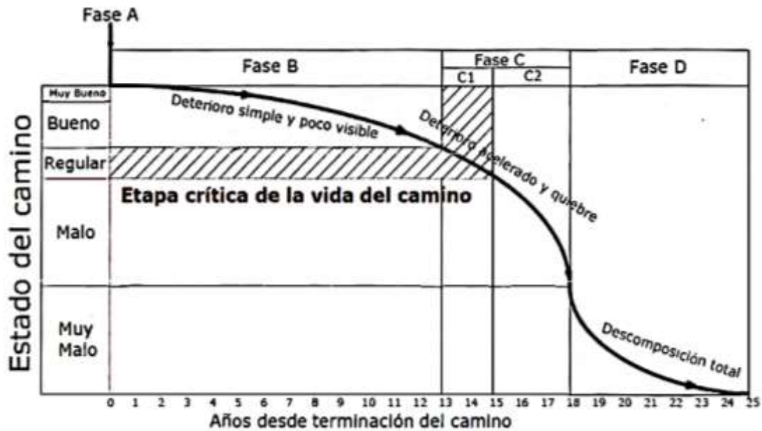
Figura N° 4: Deterioro de los caminos con el transcurso del tiempo.
