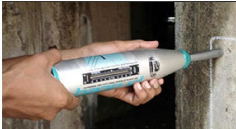
Figura 18: Esclerómetro
