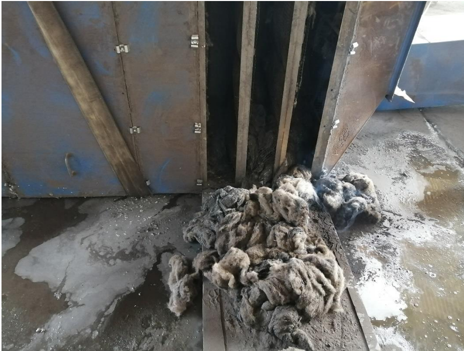
Figura N° 27: Napa emitida por máquina granalladora
