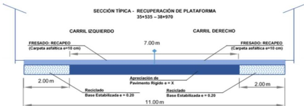
Figura 23. Sección típica tramo 4
