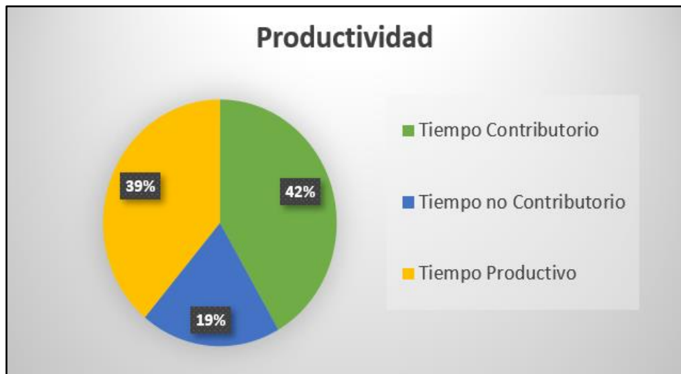
Figura 109: Productividad de la colocación de puntos del sector 5.
