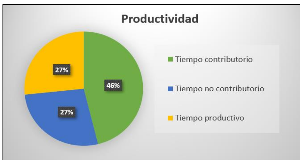
Figura 53: Productividad de la colocación de puntos del sector 1.
