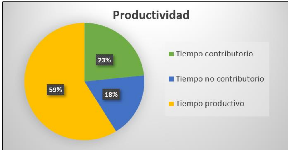
Figura 65: Productividad del tarrajeo del sector 1.
