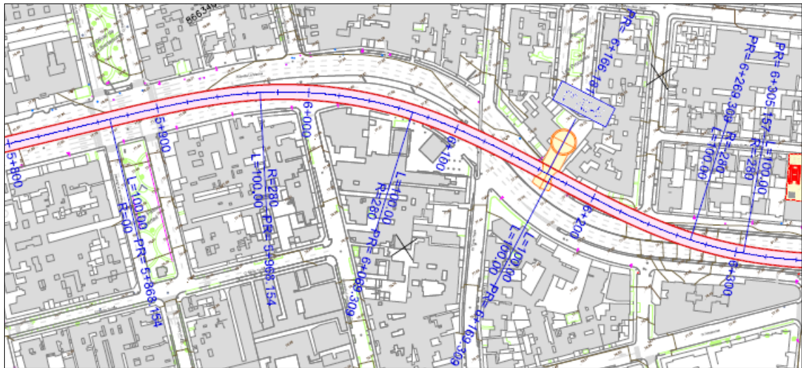
Figura 53: Radio mínimo de curva del Ferrocarril Bellavista – Santa Anita Fuente: Gobierno del Perú
