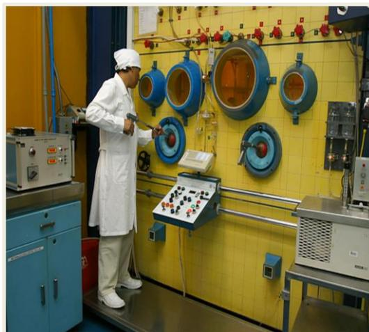
Figura 14: Recinto de producción de yoduro de sodio (I-131)
