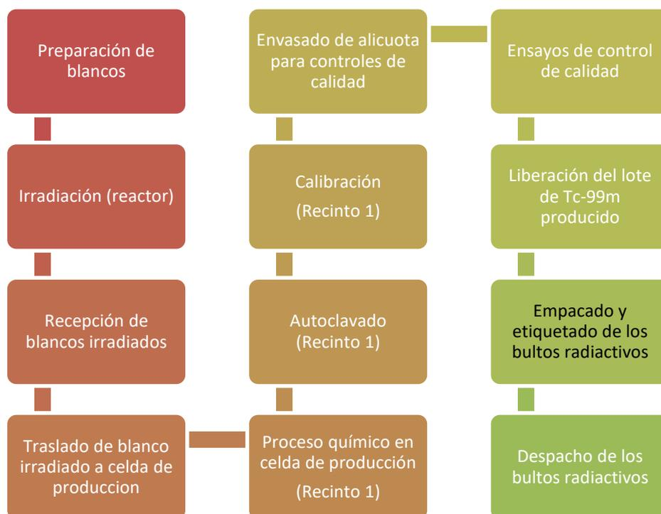
Figura 21: Proceso actual de producción de pertechnetato de sodio (Tc-99m)
