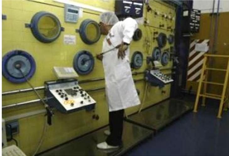
Figura 18: Recinto de producción de pertechnetato de sodio (Tc-99m)
