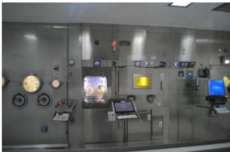
Figura 20: Recinto actual de producción de pertecnetato de sodio ( $Tc-99m$ )
