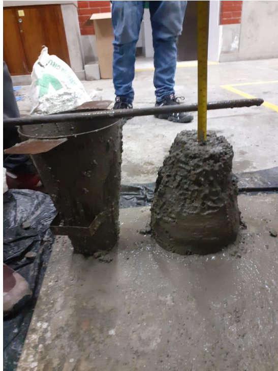
Figura 11: Ensayo de asentamiento muestreo para diseño “DP-01”
