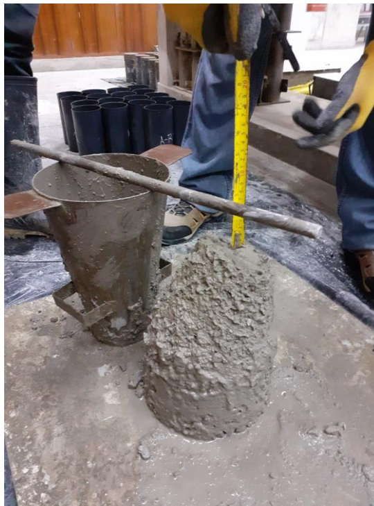
Figura 12: Ensayo de asentamiento muestreo “DP-02”
