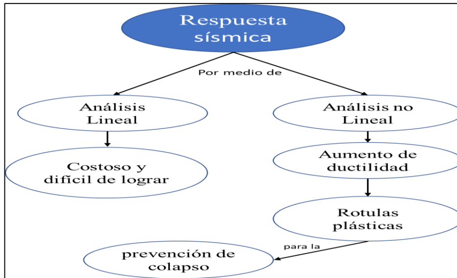
Figura 18: Diagrama de flujo del análisis no lineal
