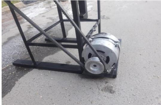
Figura N°65 Sistema de encendido y motor monofásico
