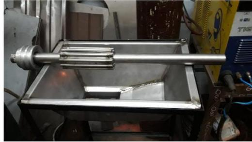
Figura N°68 Sistema de rodillos en funcionamiento
