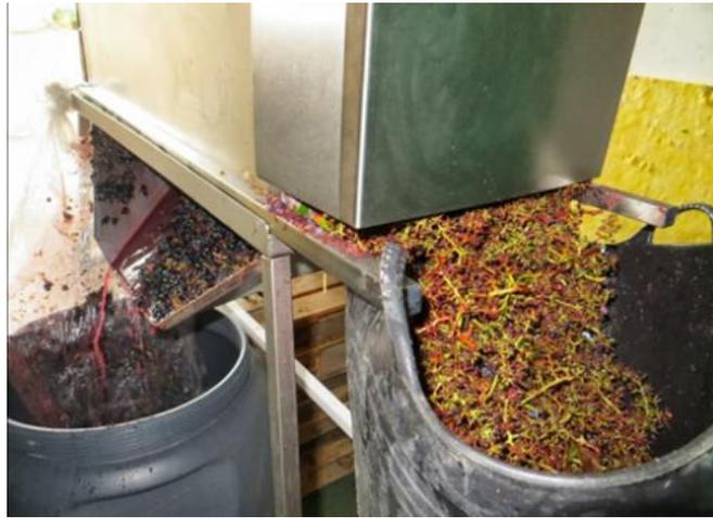
Figura N°24: Máquina estrujadora de uva.
