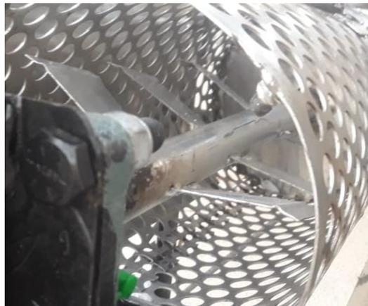
Figura N°46 Rotación de las paletas despalilladoras
