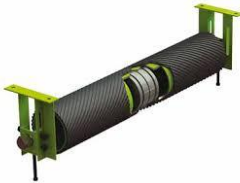
Figura 27. Diseño de los templadores de faja
