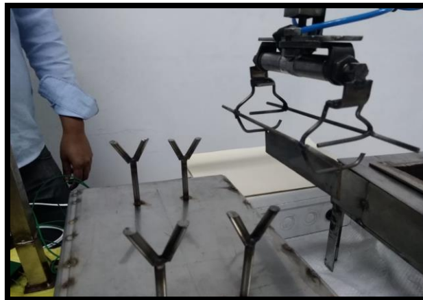
Figura 88. Matriz de sujeción llegando a módulo de base final Fuente: Elaboración propia
