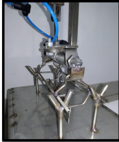
Figura 87. Sujeción de la matriz en su posición inicial Fuente: Elaboración propia
