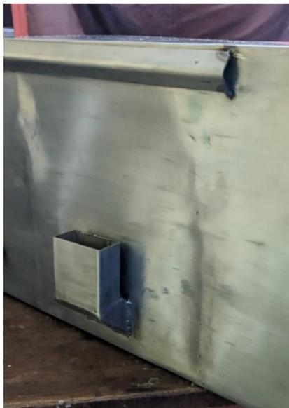
Figura N° 84: Desfogue de la cámara de secado
