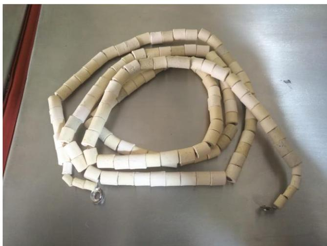
Figura N° 56: Resistencia de 90  $\Omega$
