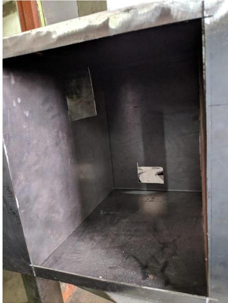
Figura N° 77: Construcción del chasis de la cámara de secado de café
