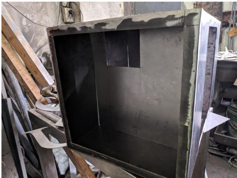
Figura N° 76: Construcción del chasis de la cámara de resistencia eléctrica
