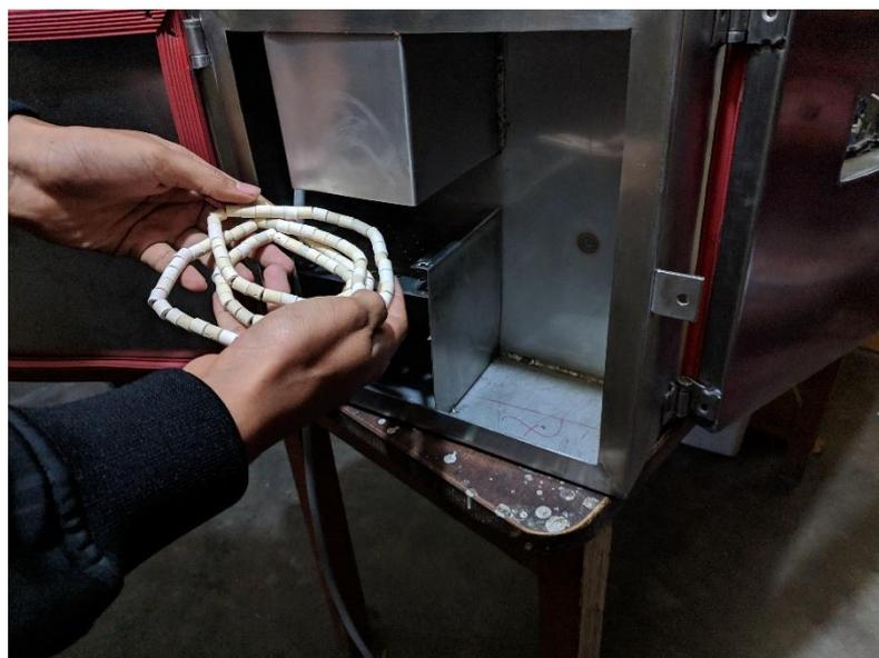
Figura N° 91: Resistencia eléctrica de 90 ohmios
