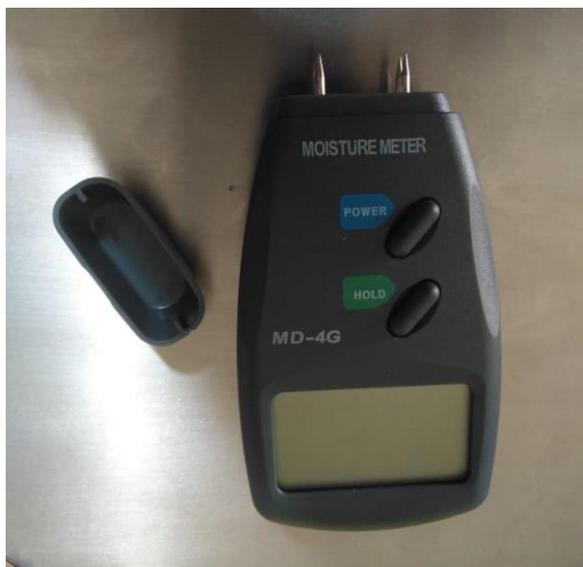
Figura N° 100: Medidor de humedad
