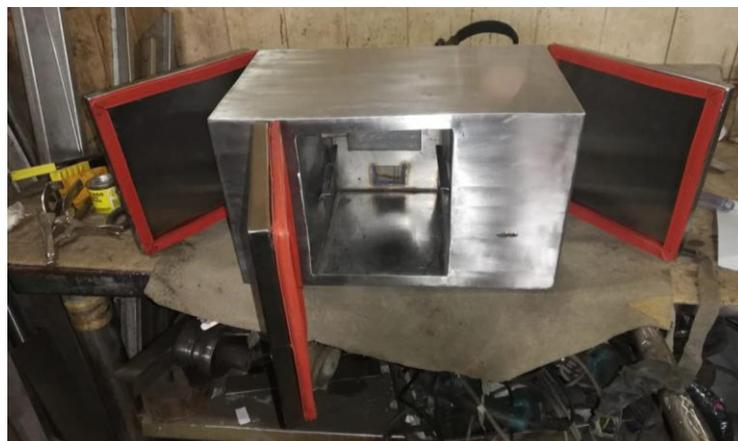
Figura N° 86: Puertas instaladas en el prototipo de secado de café
