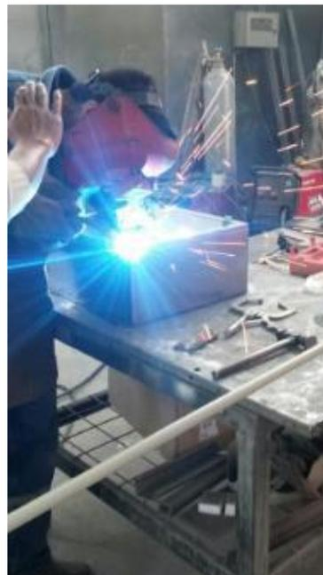
Figura N° 80: Proceso de soldadura con la maquina TIG 250
