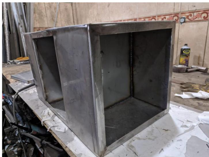
Figura N° 78: Construcción del chasis de la cámara de control del secado de café
