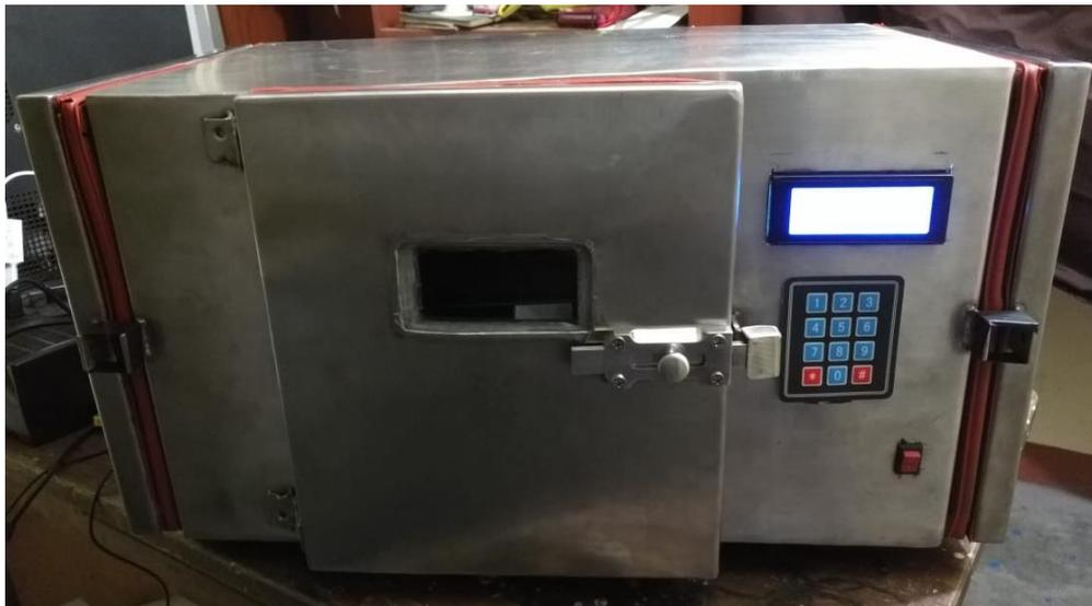
Figura N° 98: Switch On-Off, tablero de control y LCD Display
