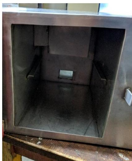
Figura N° 82: Cámara de secado de café
