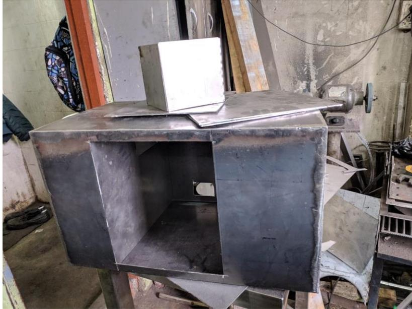
Figura N° 75: Construcción del chasis del secador de café
