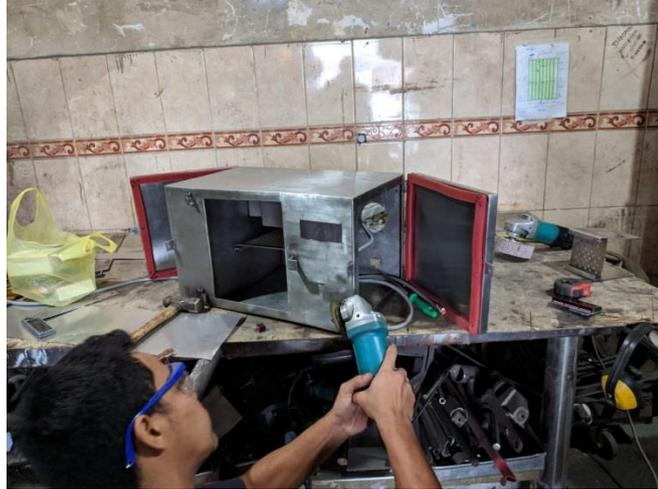
Figura N° 87: Aberturas elaborada con esmeril MAKITA en la cámara de control
