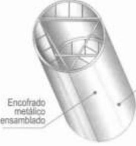
Los encofrados deben limpiarse y repasarse con petróleo antes de colocarse, para facilitar el desencofrado.
