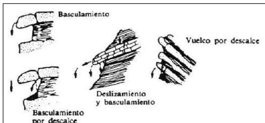
Figura N° 2.3: Tipos de Desprendimientos
