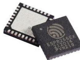
Figura N° 16: Soc ESP8266EX
