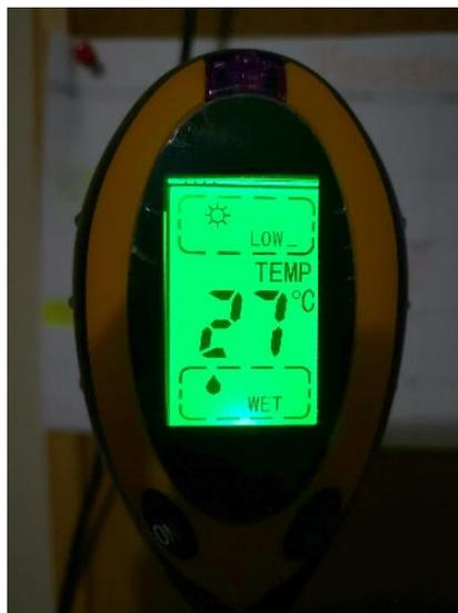
Figura N° 145: Sensor de temperatura, cantidad de luz, humedad de suelo y Ph.
