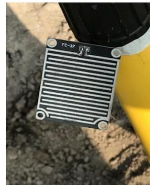
Figura N° 120: Acondicionamiento de Sensor de Lluvia
