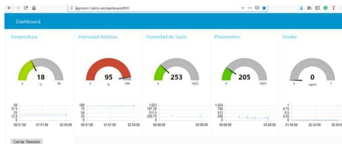
Figura N° 130 : Dashboard de las 5 variables física a medir
