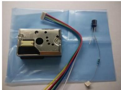
Figura N° 30 : Sensor Sharp GP2Y1010AU0F
