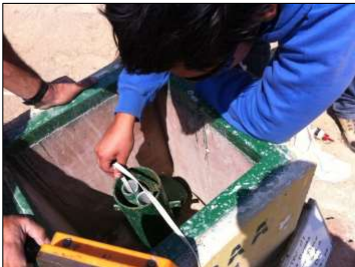
Foto N° 4.5.5: Verificación de la medida obtenida con el limnómetro.
