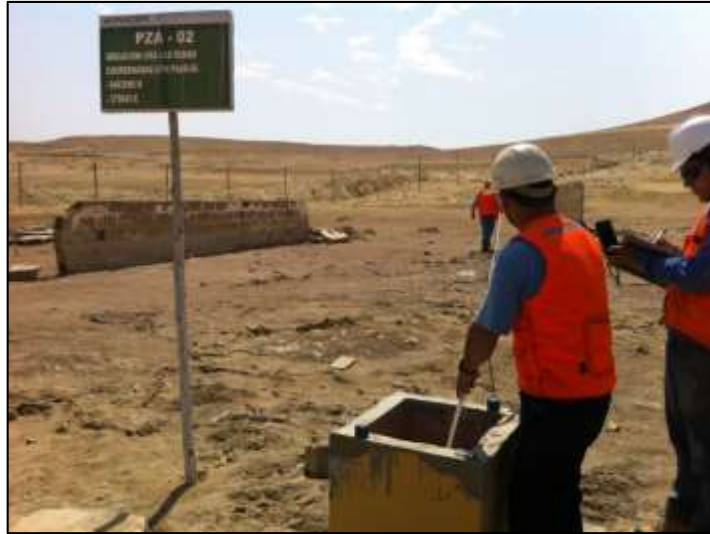
Foto N°4.5.2: Proceso de extracción del tubo saca-muestras.
