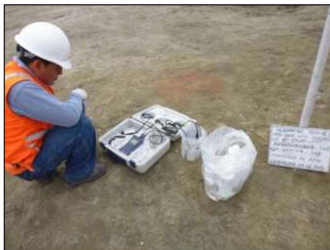
Foto N°5.3.3: Verificación de datos y registro de resultados obtenidos en campo con el Multiparámetro WTW, modelo 350i.
