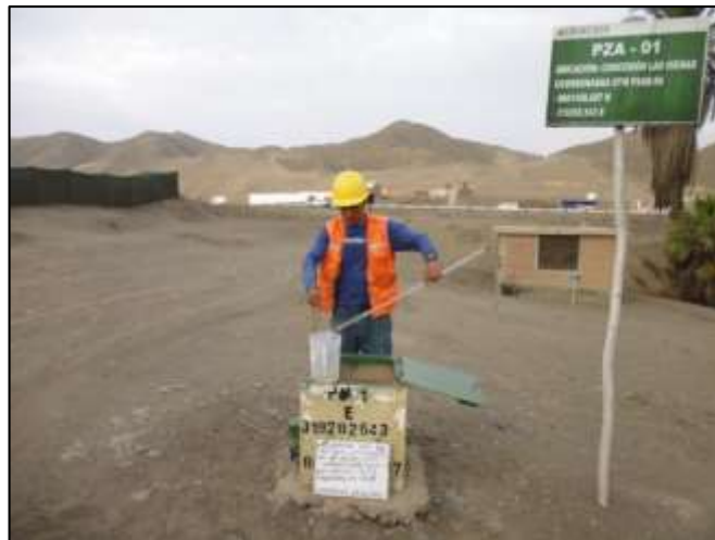
Foto N°5.3.1: Extracción de muestras de agua del piezómetro.
