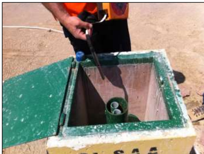
Foto N° 4.5.3: Verificación de la medida obtenida con el limnímetro.
