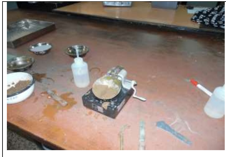
Fotografía 17. Se gira la manivela hasta que las partes intermedias se juntan.
