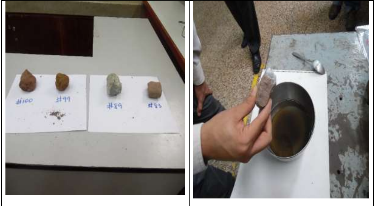
Fotografía 26. Cubrimiento de la muestra con parafina, para eliminar el aire atrapado.
