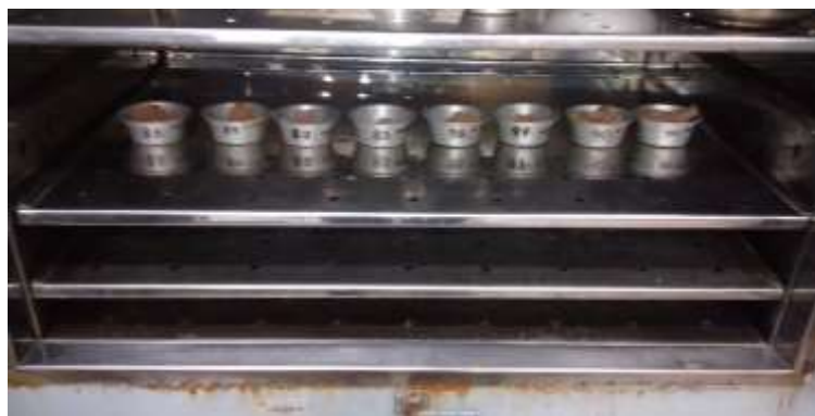
Fotografía 10: Secado de la muestra húmeda en el horno
