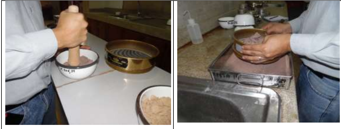
Fotografía 11 y 12: Tamizado de muestra por la malla #40.
