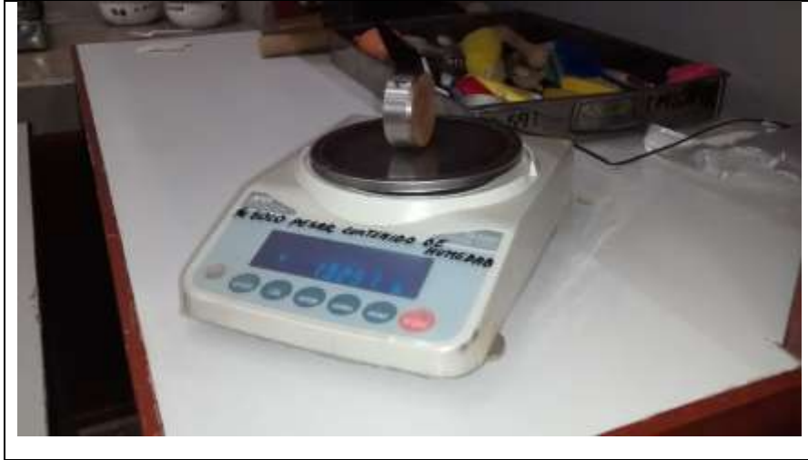
Fotografía 34. Pesaje de la muestra más anillo antes de ensayar.
