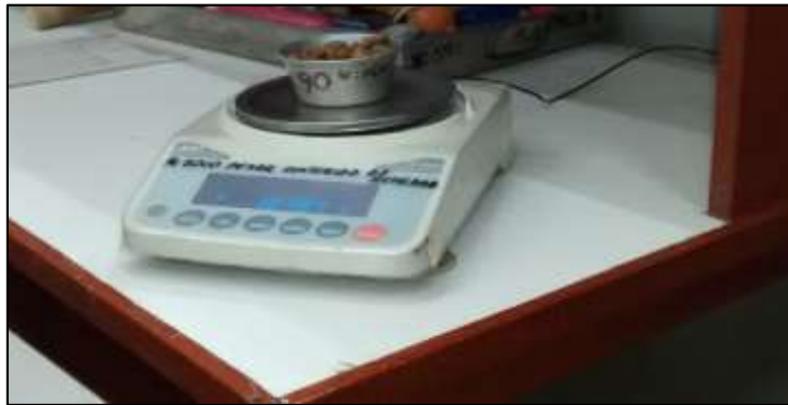
Fotografía 9: Obtención de muestras para el contenido de humedad
