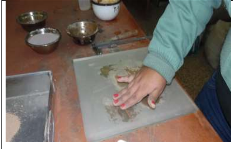
Fotografía 19. Formación de cilindros sobre el vidrio poroso para absorber el agua.
