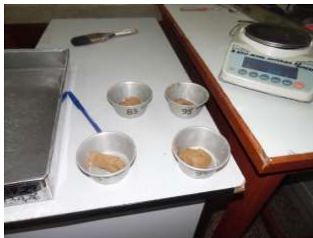
Fotografía 18: Extracción de muestras de la parte intermedia de la copa de Casagrande para la obtención del contenido de humedad.
