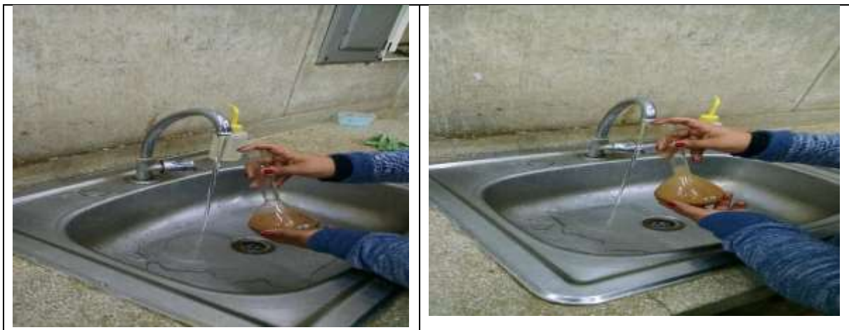
Fotografía 23. Colocación de mezcla del suelo con agua en el Picnómetro
