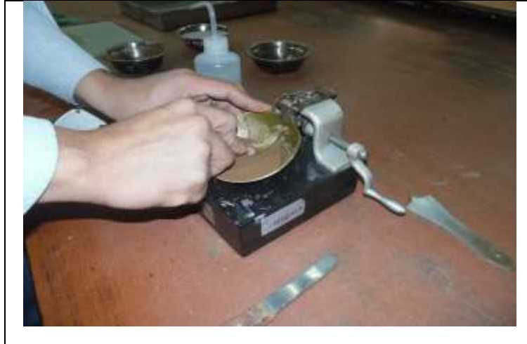
Fotografía 16: Realización de un surco en la parte media de la muestra con un acanalador.
