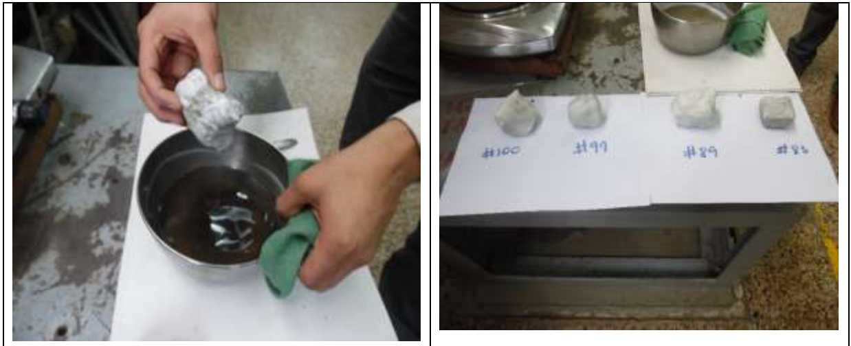
Fotografía 27. Cubrimiento de la muestra con parafina, para eliminar el aire atrapado.
