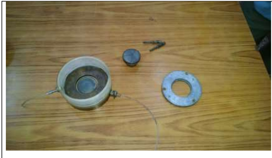
Fotografía 35. Colocación de piedras porosas.
