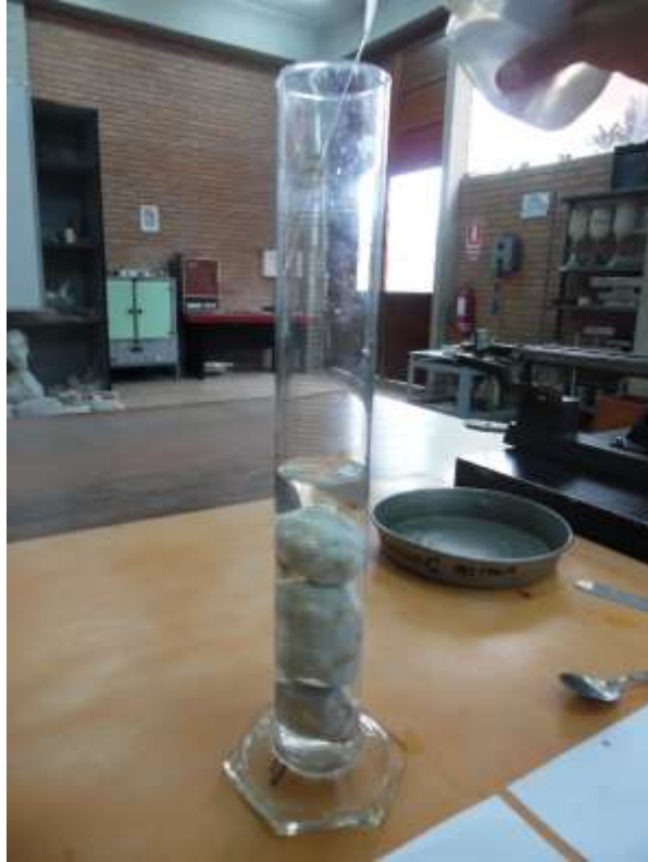
Fotografía 6: Sumersión de muestras para determinar el peso
