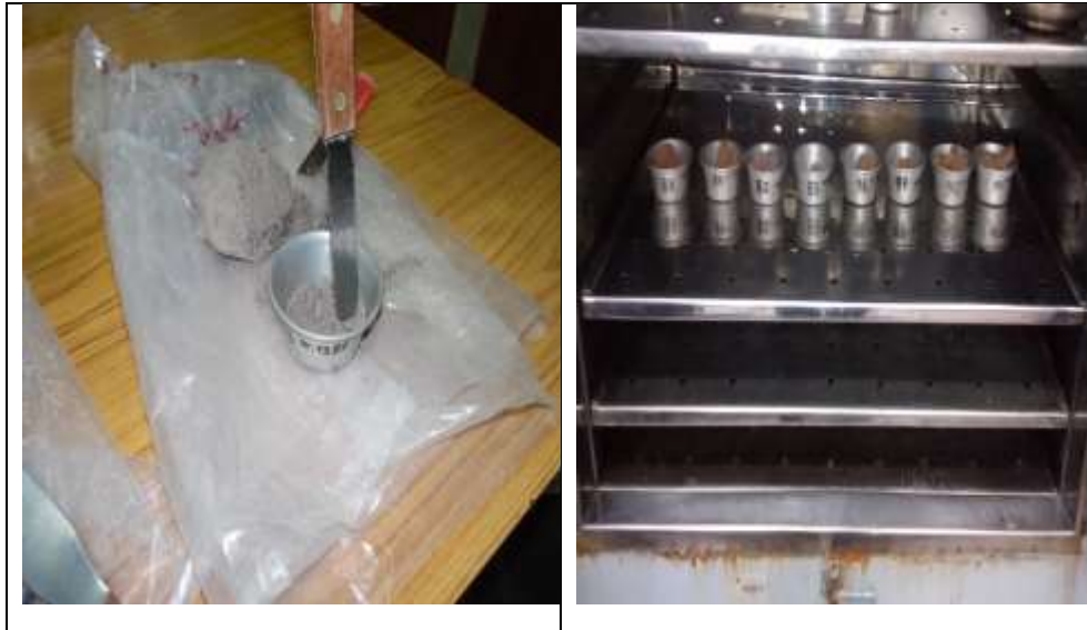
Fotografía 3 y 4: Ensayo de contenido de humedad.
