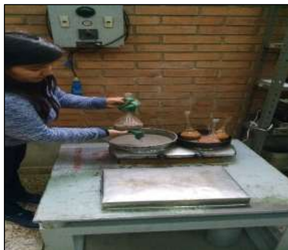
Fotografía 24. Remoción del aire atrapado.
