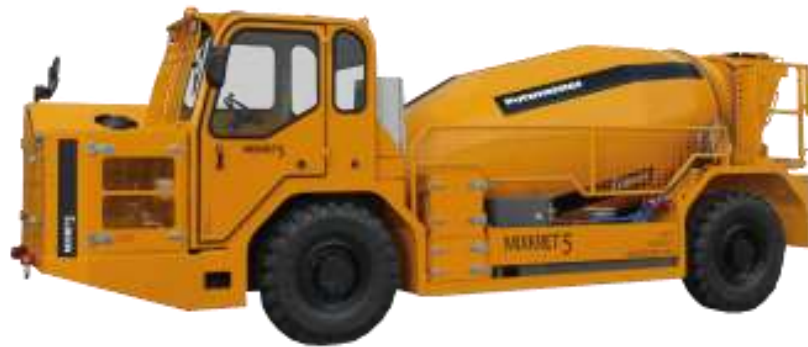
Figura 10 Equipo de mezclado y transporte de concreto (Mixkret 5 – Putzmeister),
