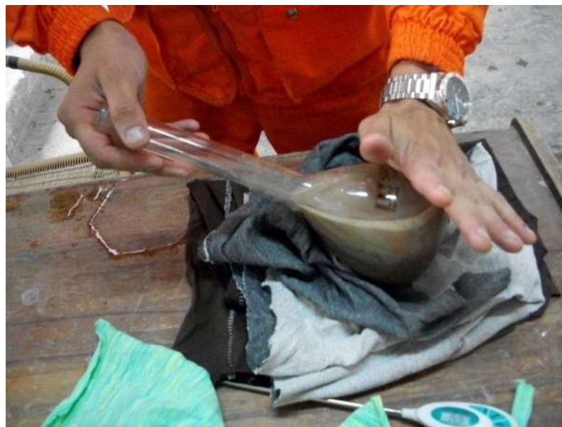
Figura 32 Eliminación de Vacíos
