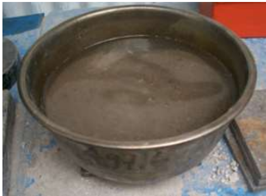
Figura 29 Saturación del agregado por 24 horas.
