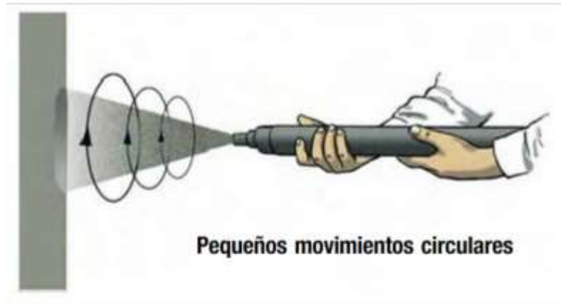
Figura 5 Manejo de la manguera. (Mediante pequeños movimientos circulares)
