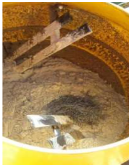
Figura 22 Adición de fibra en la mezcla de laboratorio,
