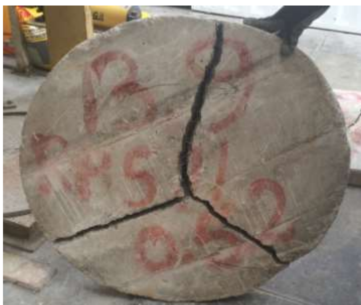
Figura 41 Muestra ensayada con falla radial. Fuente: Elaboración propia.
