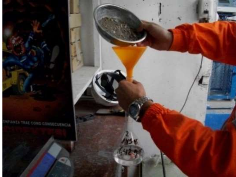
Figura 31 Inmersión de agregado dentro de la Fiola
