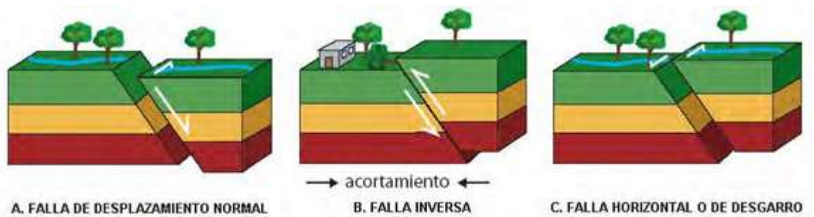
FIGURA N°05: Tipos de Falla: Normal, inversa y horizontal o de desgarro. Fuente: USGS
