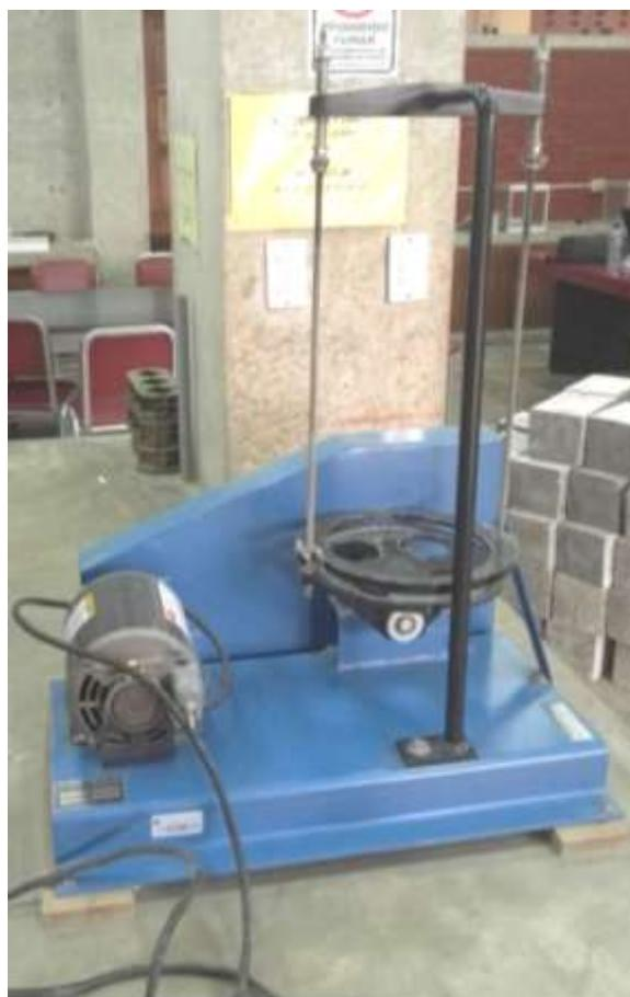
*Ilustración 1: Tamizador eléctrico*
