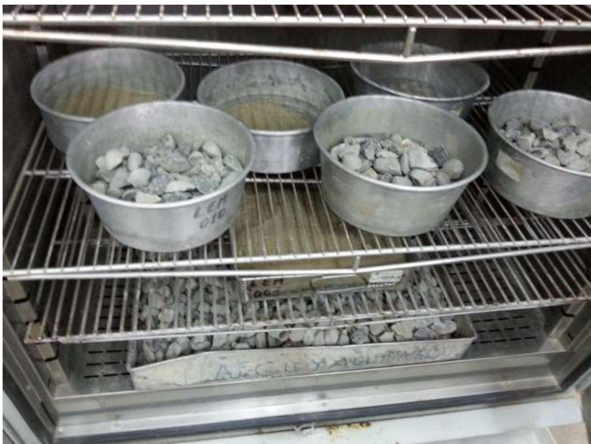
SECADO DE AGREGADOS
