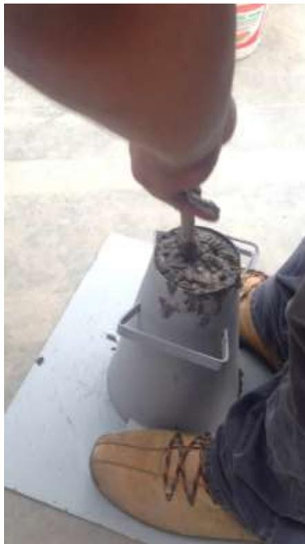
EJECUCION DE PRUEBA DE ASENTAMIENTO – SLUMP FLOW
