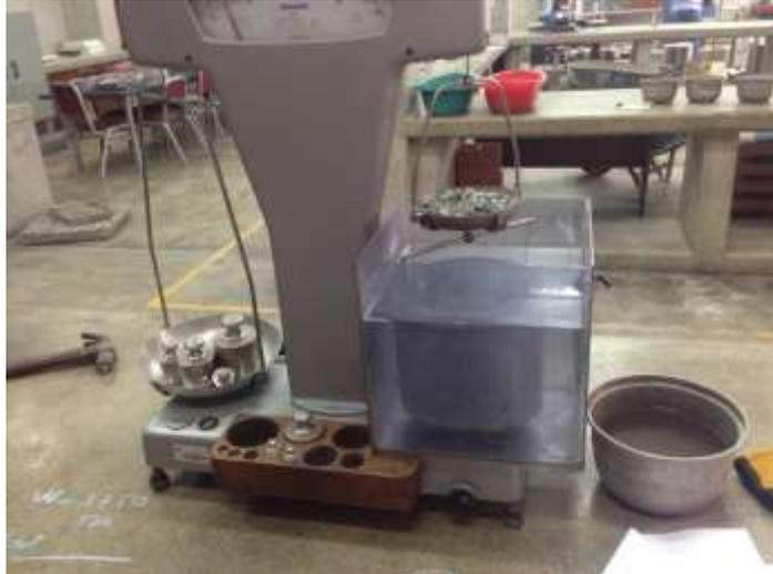
**PESO ESPECÍFICO DEL AGREGADO GRUESO**
