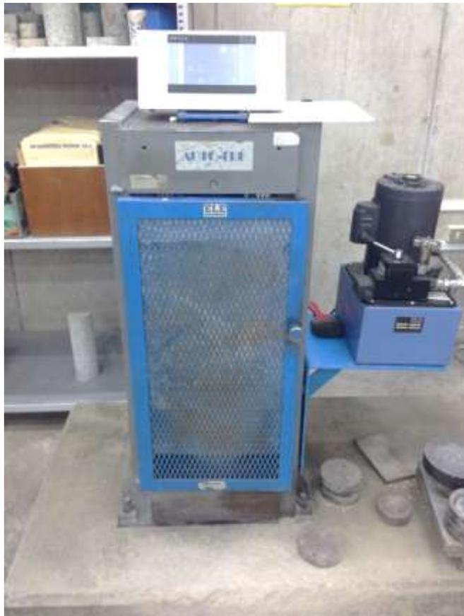
*Ilustración 3: Maquina de Compresión Axial Electro-Hidráulica*
