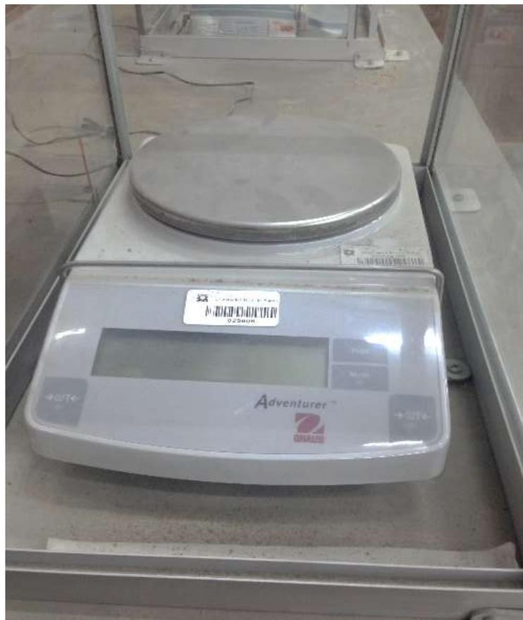
*Ilustración 5: Balanza de Funcionamiento No Automático*
