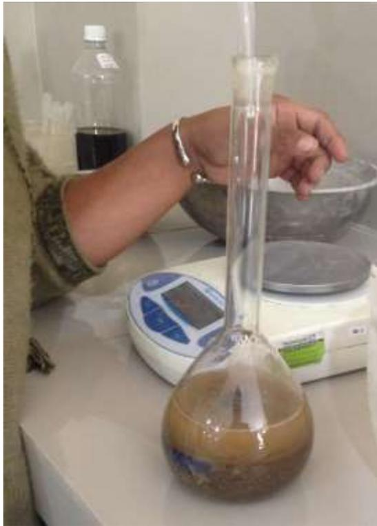
PESO ESPECÍFICO DEL AGREGADO FINO – FIOLA
