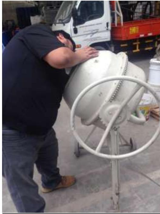
HUMEDECIMIENTO DE TROMPO PARA ENSAYOS DE CONCRETO FRESCO
