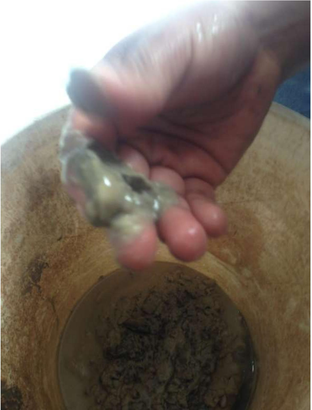
FRAGUADO NO LOGRADO CON CONCRETO SUMERGIDO EN AGUA
