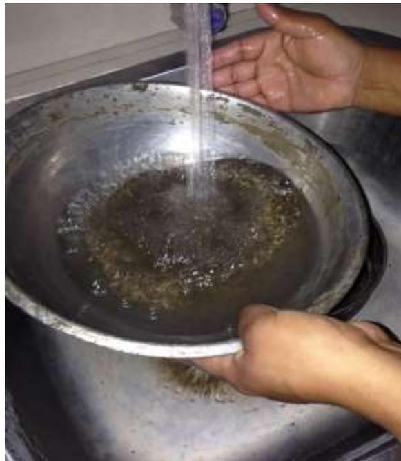
*Ilustración 27: Lavado de Agregado Fino, para malla #200*
