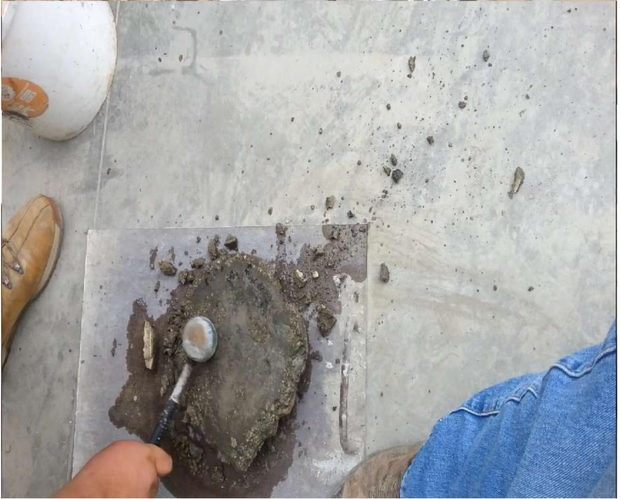
MEZCLA FRAGUADA Y ENDURECIDA EN 24 HORAS PARA DISEÑO
