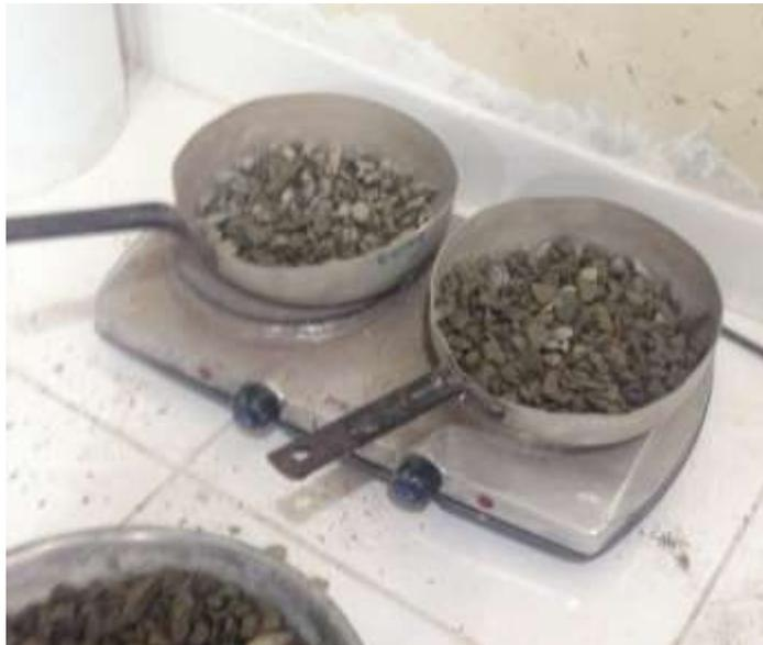
HORNILLAS SECANDO AGREGADO GRUESO
