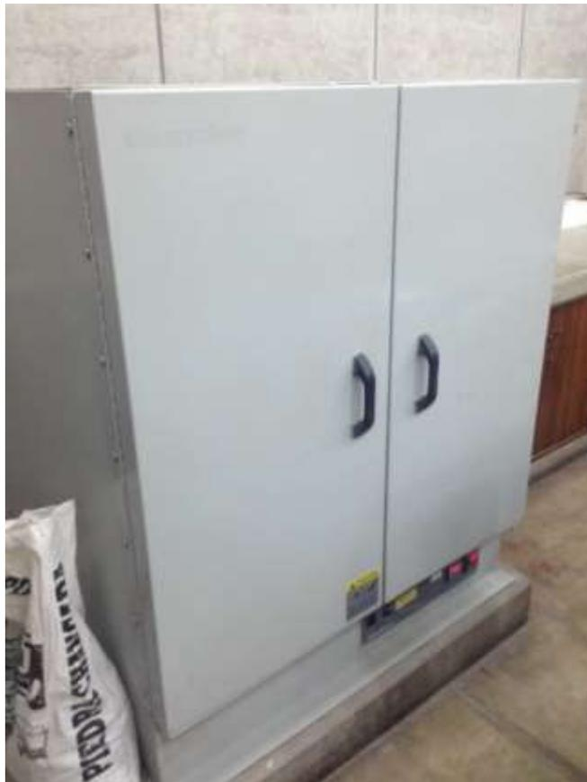
*Ilustración 4: Horno de secado para las muestras*
