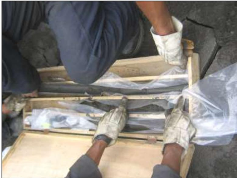
**Figura 55.** Secuencia de recuperación de muestra con la porteadora manual y caña partida del SPT para control de humedad con la profundidad
