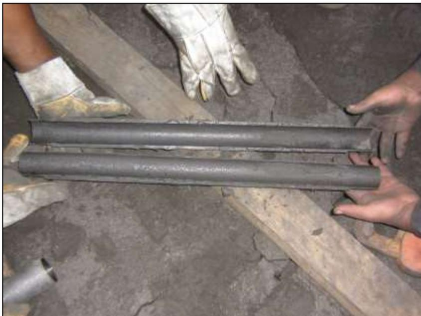
**Figura 52.** Procedimiento de recuperación de muestra con la caña partida después de evaluar la resistencia del relave, colocándose de forma secuencial dentro de la caja porta testigo.
