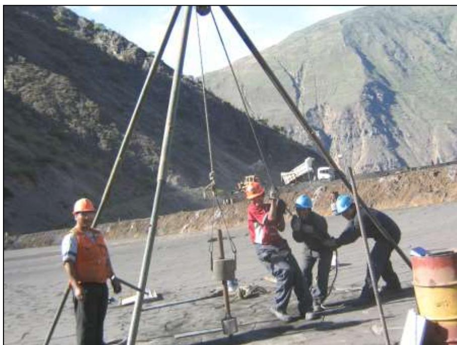
**Figura 53.** Uso de la posteadora manual tipo AUGER para recuperar muestras de forma continua y para alcanzar el inicio del ensayo de resistencia SPT.
