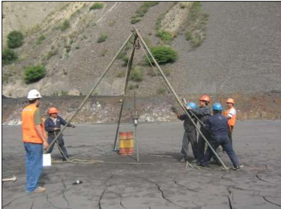
**Figura 51.** Procedimiento de prueba del ensayo SPT dentro del depósito de relaves en la presa Norte
