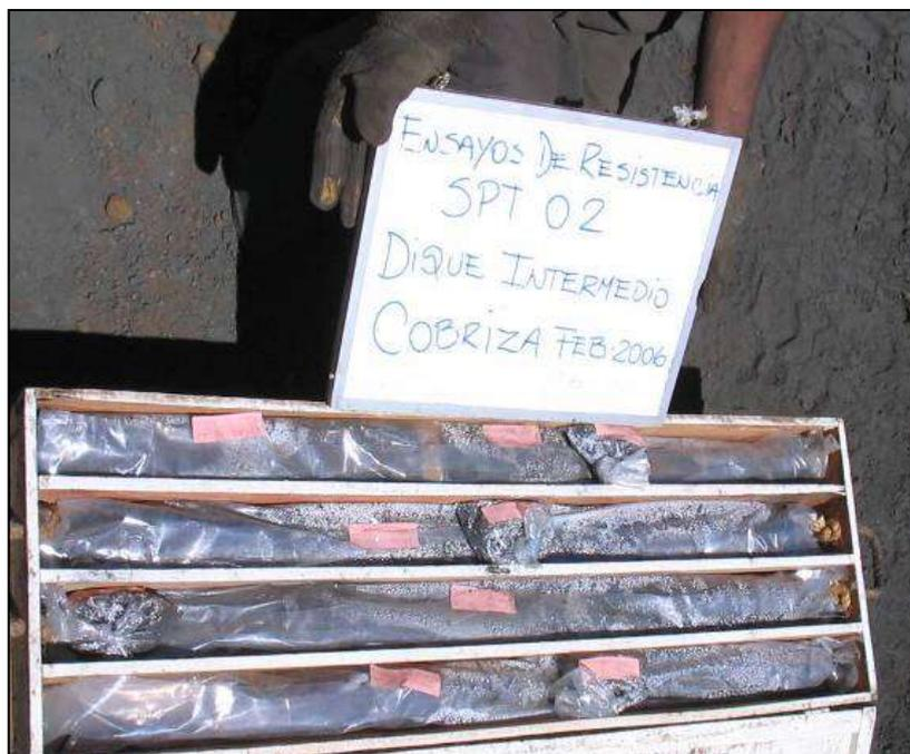
**Figura 39.** Secuencia del equipo SPT y recuperación de muestra con la caña partida.
