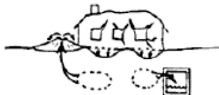
(b) Abultamiento secundario del suelo debido a la erosión de la erupción de un volcán de arena
