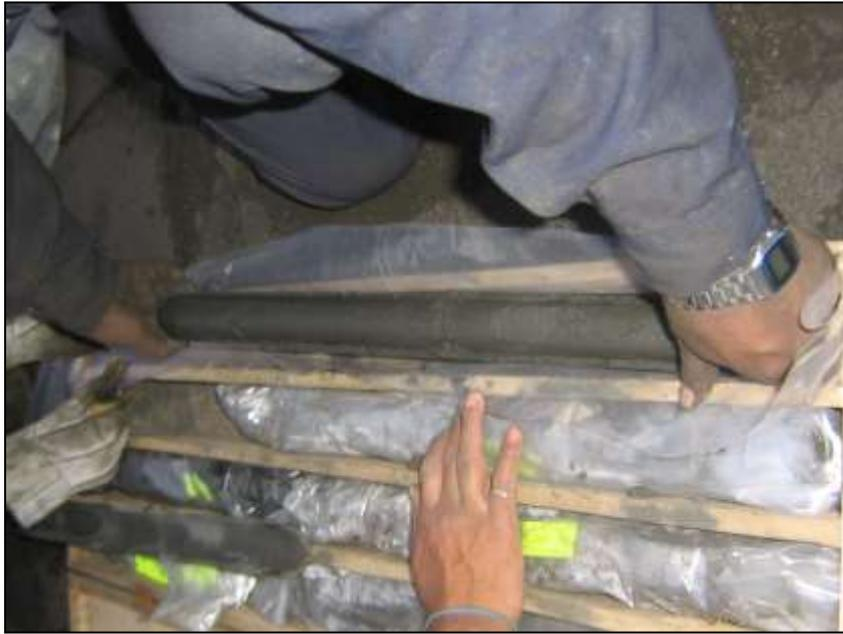
**Figura 54.** Forma de obtención de las muestras con la caña partida que es colocado en la caja porta testigo para sus ensayos de laboratorio.
