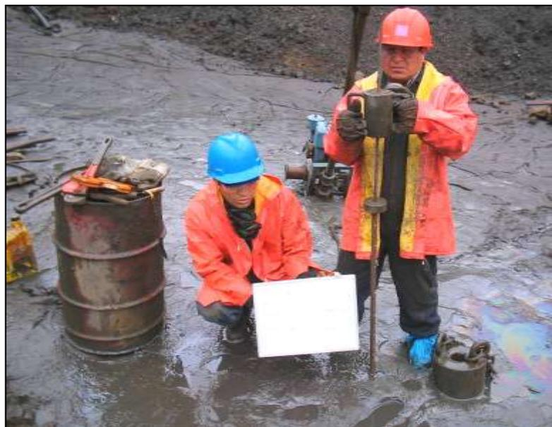
**Figura 40.** Secuencia de los trabajos de resistencia con el DPL
