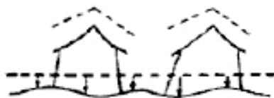
(a) Abultamiento de terreno debido a densificación cíclica y/o reconsolidación volumétrica
