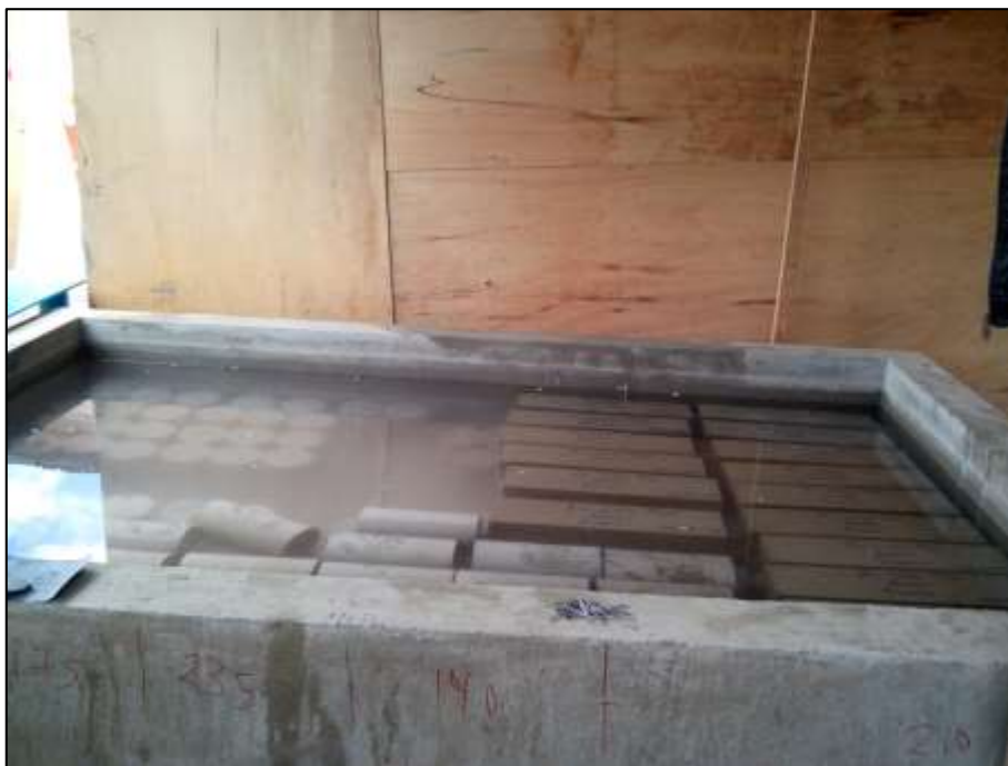
Poza de curado con las vigas y probetas cilíndricas
