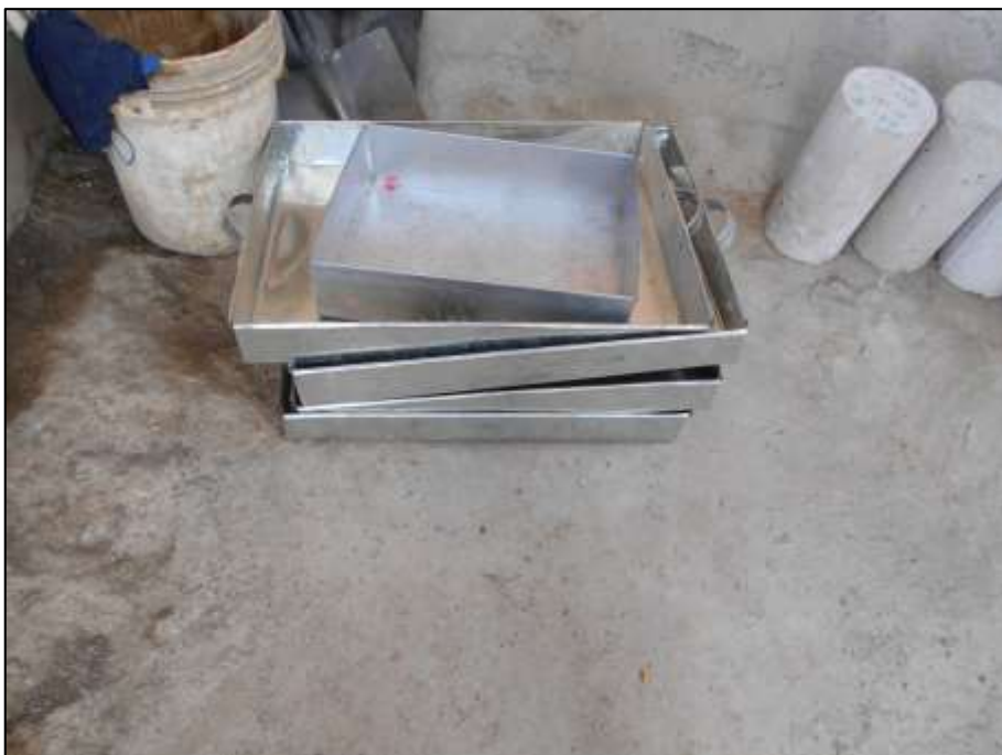
Bandejas para almacenar los agregados y cemento
