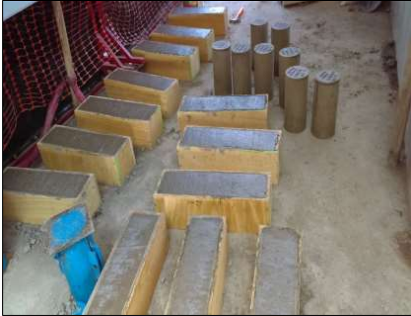
Figura 27: Probetas cilíndricas y vigas de concreto
