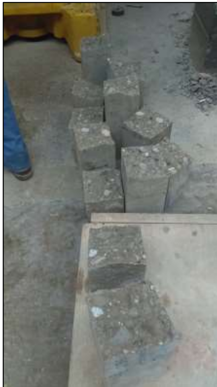
Rotura de vigas
