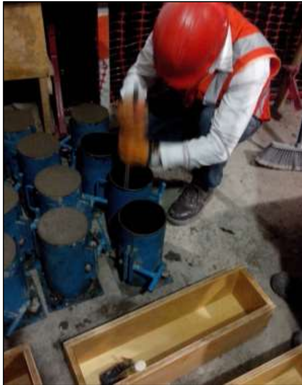
Hincado a la mezcla con varilla de acero dentro de las probetas cilíndricas
