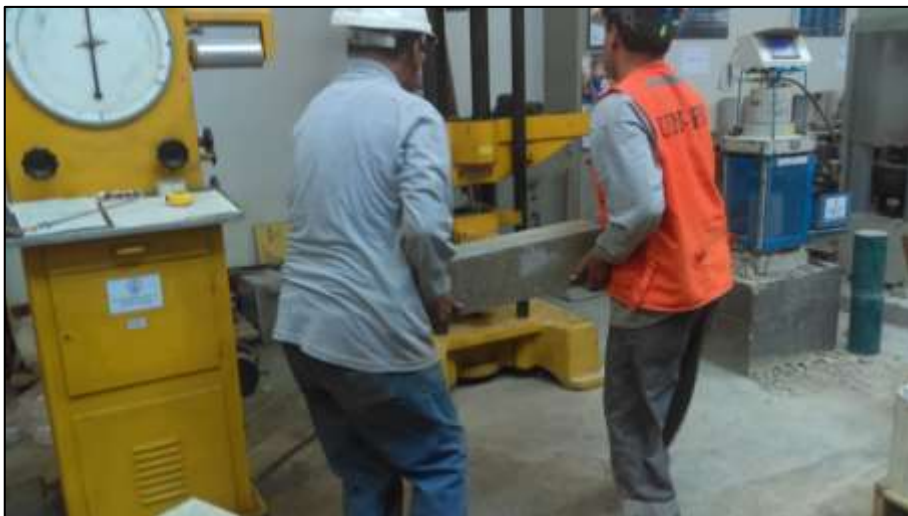
Colocación de las vigas en la maquina universal
