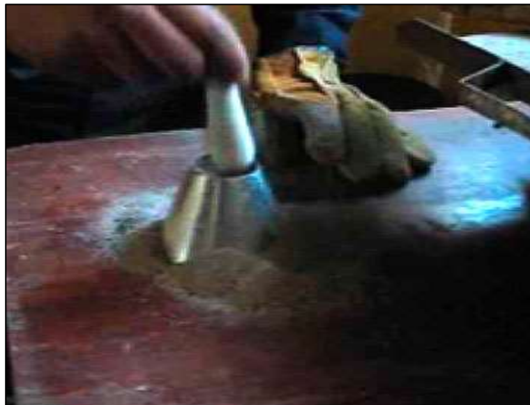
Figura 18: Compactación del agregado fino
