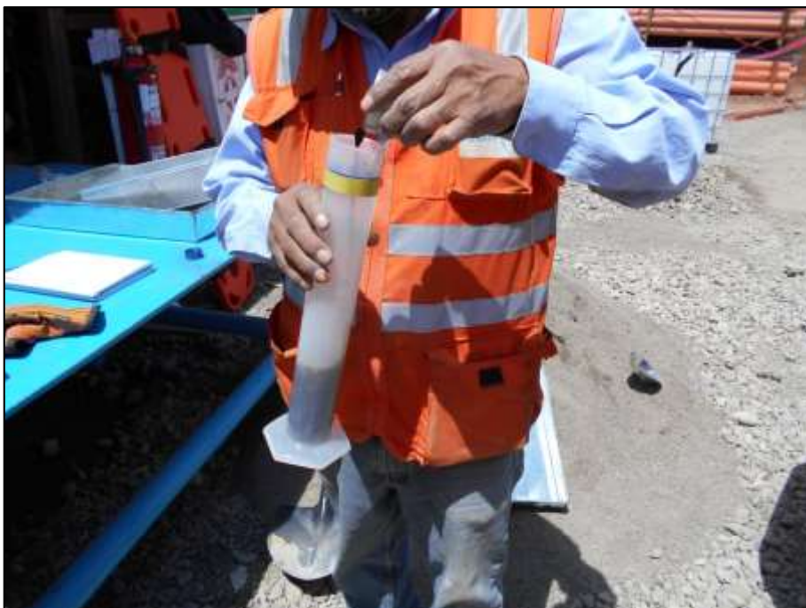
Mezclado de los Aditivos con el agua
