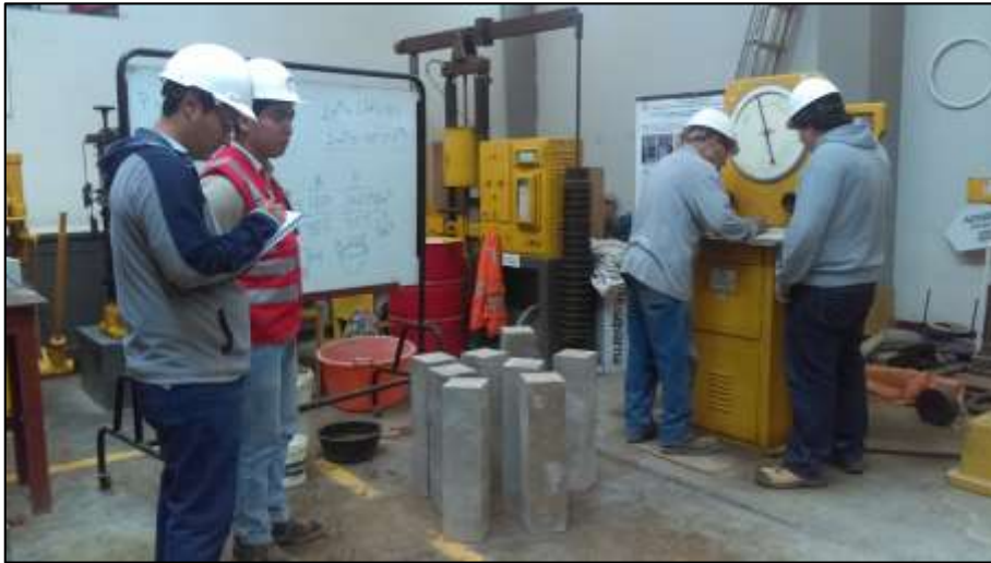
Preparación de las Vigas de concreto
