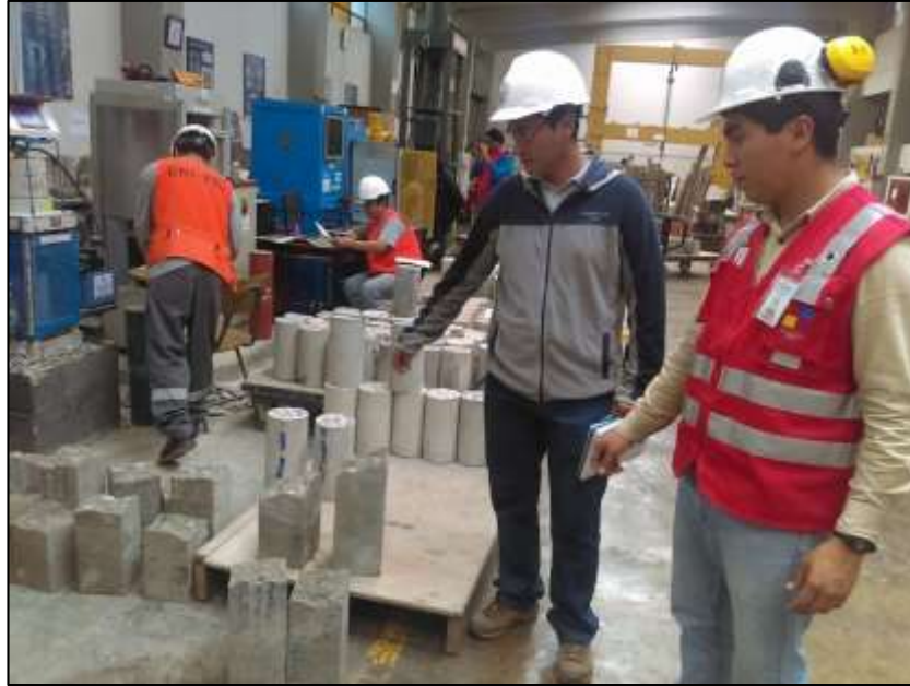
Figura 31: Vigas en estado de falla (Rotura)
