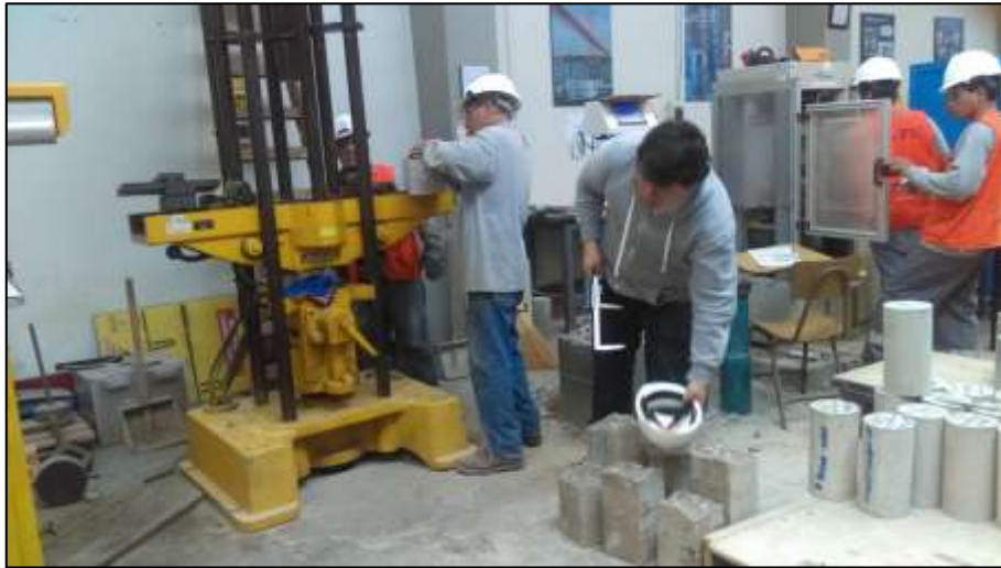
Medición de la rotura de viga
