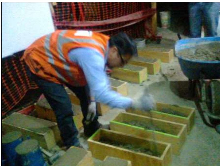
Hincado a la mezcla con varilla de acero dentro de las Vigas
