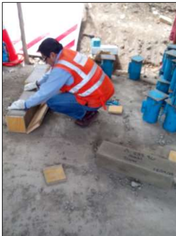
Desmoldado de las probetas cilíndricas y vigas
