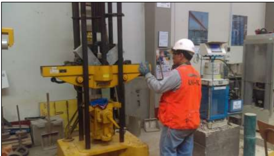
Rotura de la Viga
