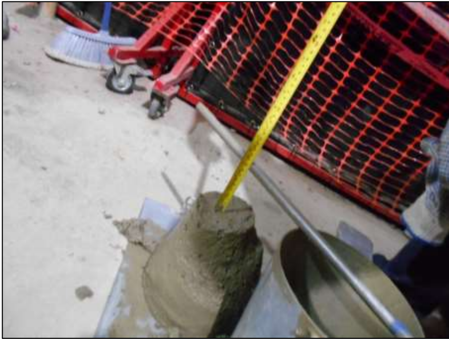
Medición del Slump
