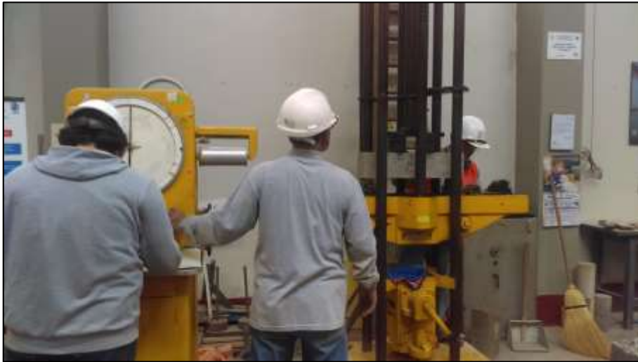
Aplicación de la carga sobre la viga
