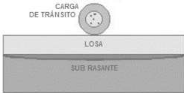
Figura 04: Transmisión de carga en un Pavimento Rígido
