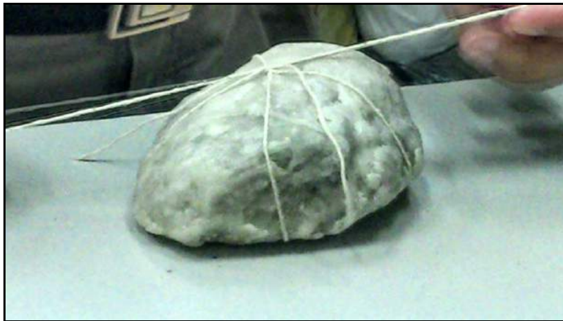
Foto 13. Muestra con parafina atada a un pabilo
