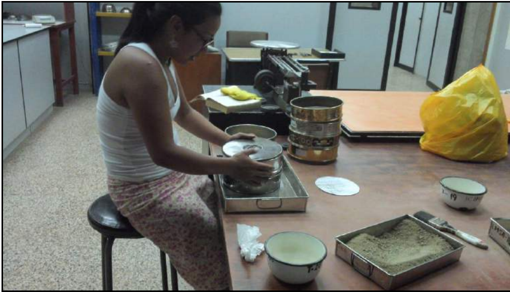
Foto 19. Ensayo de granulometría
