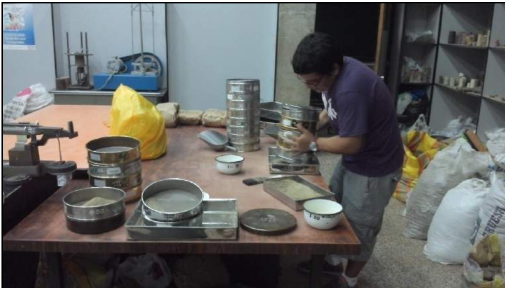
Foto 18. Proceso de pasar las muestras de suelo por los tamices
