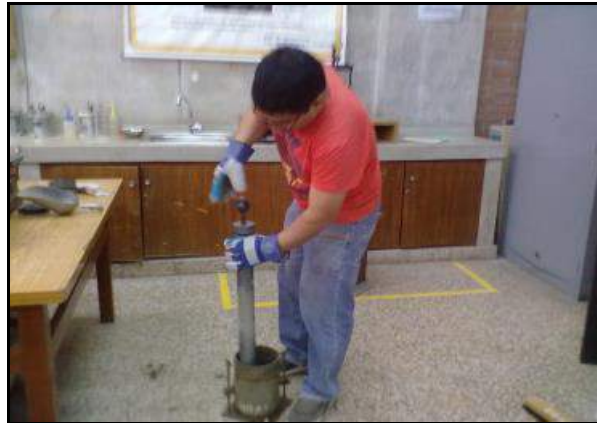
Foto 33. Realización del ensayo CBR, compactación
