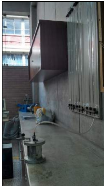
Foto 30. Conexión del recipiente con las mangueras que ingresarán agua al material
