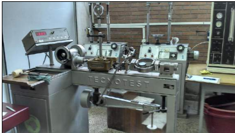
Foto 22. Equipo usado en el ensayo del corte directo
