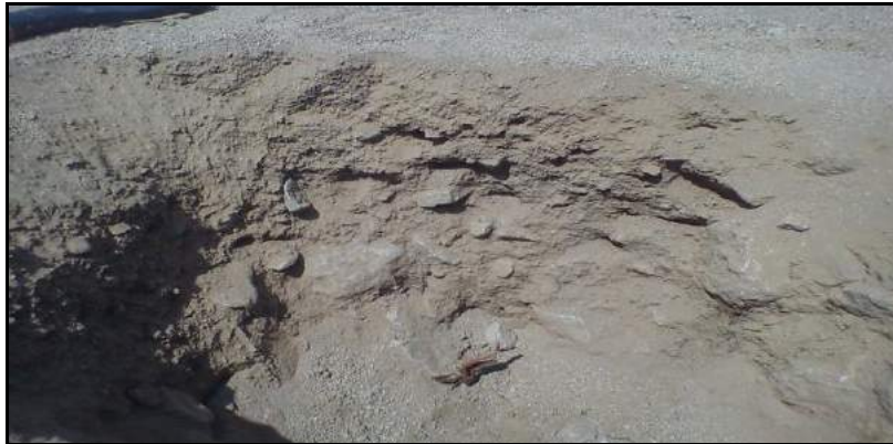
Foto 7. Muestra M-2 material con presencia de finos y rocas angulares
