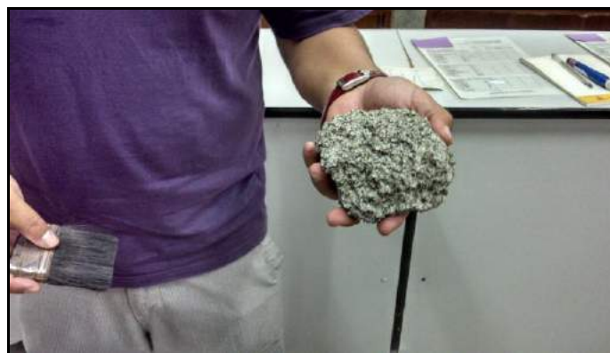
Foto 8. Muestra de Suelo Compactada
