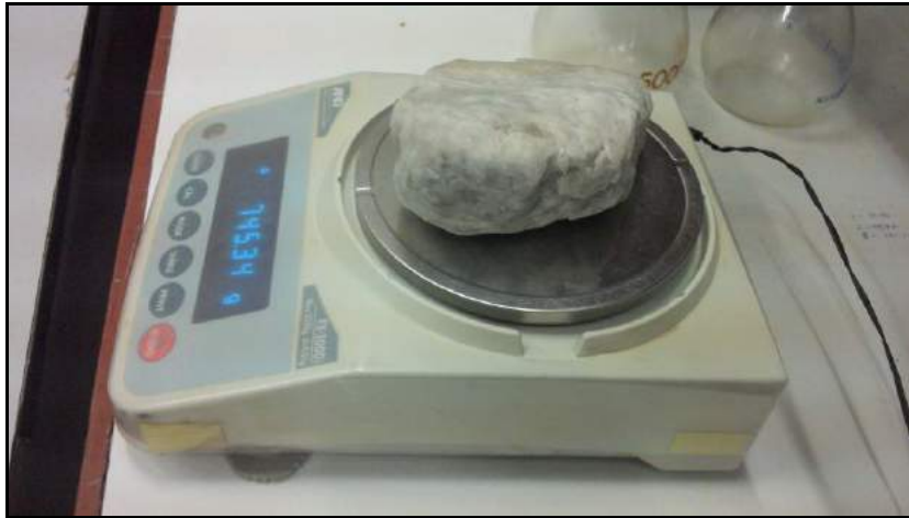
Foto 12. Muestra totalmente bañada en parafina
