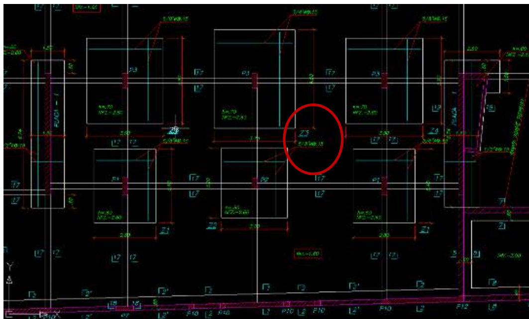
Figura:05-11: Plano E – 02: La columna P3 indica dimensiones de 0.25x0.65
