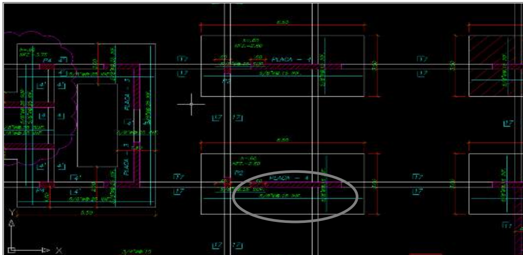
Figura 05-07 : Plano E – 02: Las placa P4 tiene dimensiones de 0.25x3.60 m.
