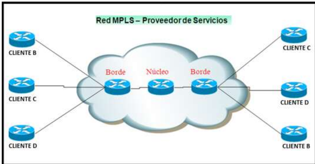
Figura 2.1 Estructura básica de MPLS de cada cliente
