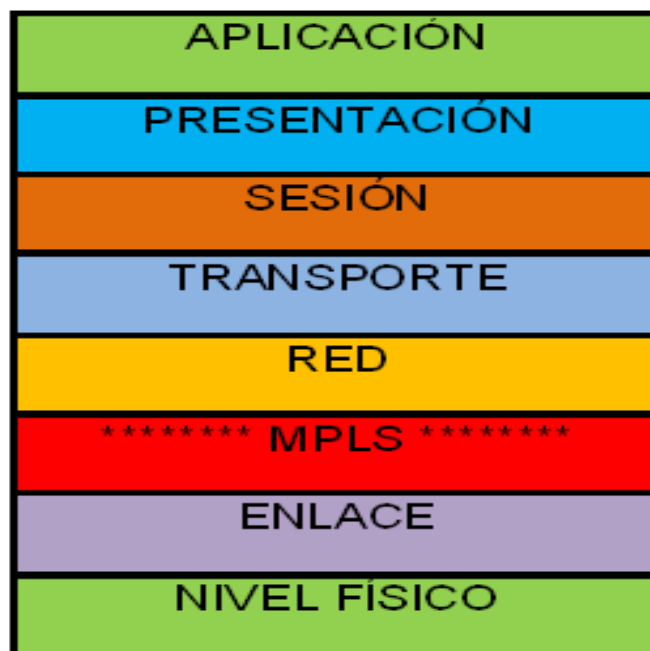
Figura 2.6 MPLS protocolo que opera entre la capa 2 y 3 del modelo OSI.
