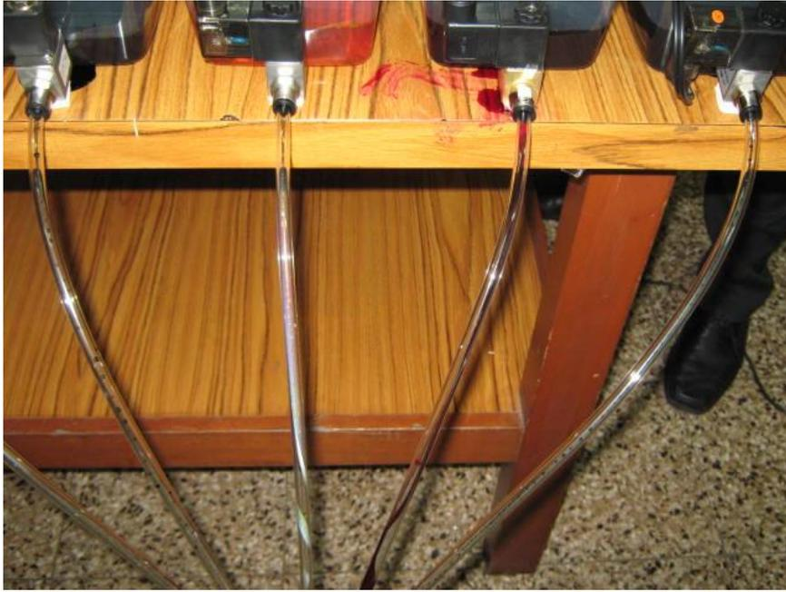
FIGURA (58) APERTURA DE LA VÁLVULA CON EL COLOR MAGENTA
