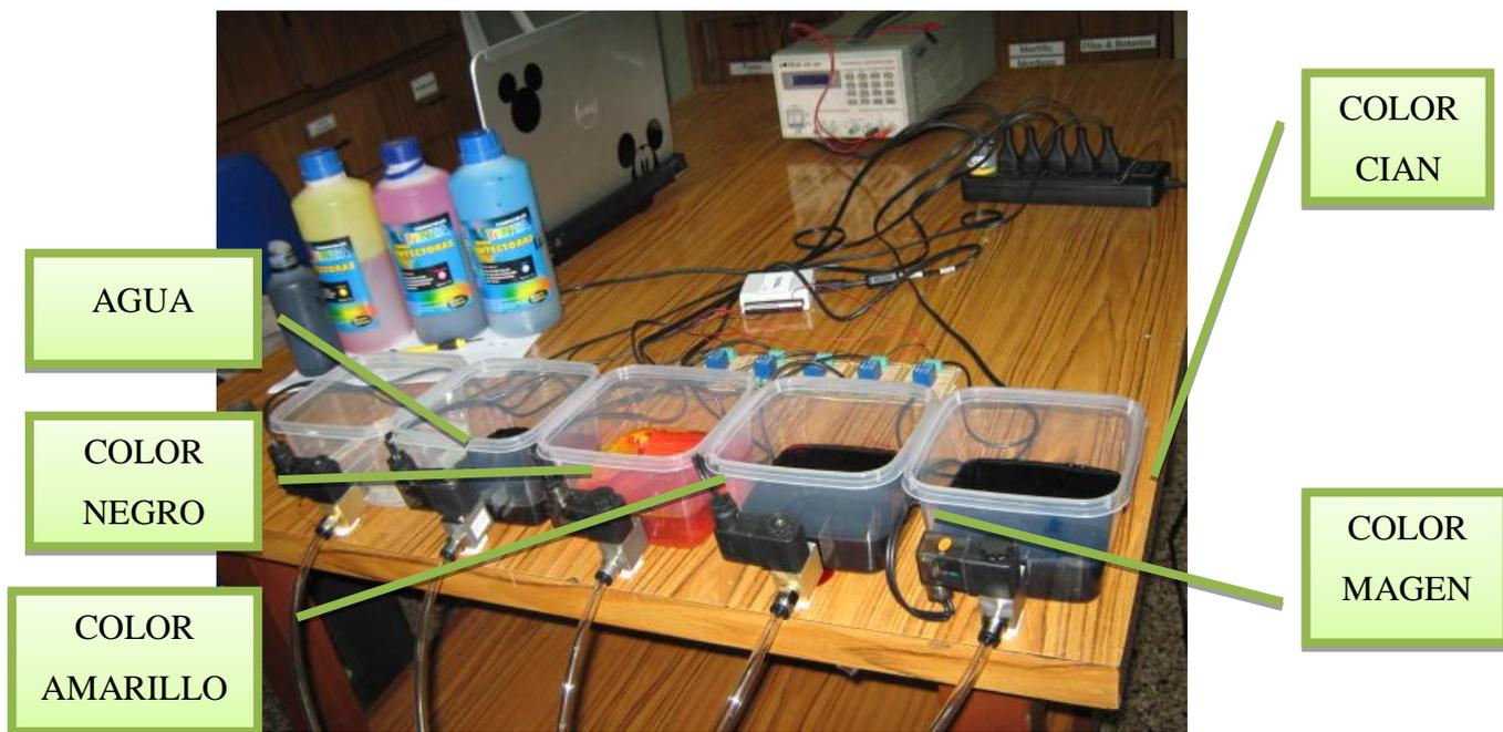
FIGURA (56) VACIADO Y UBICACIÓN DE LAS PINTURAS
