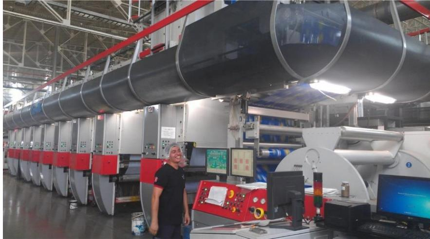
Figura 10: Maquinas de Rotogravado
