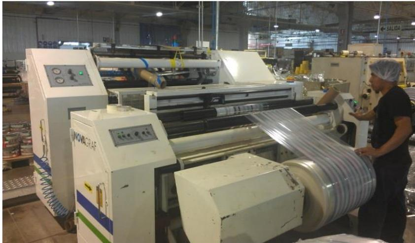
Figura 12: Maquinas de Gofrado y corte
