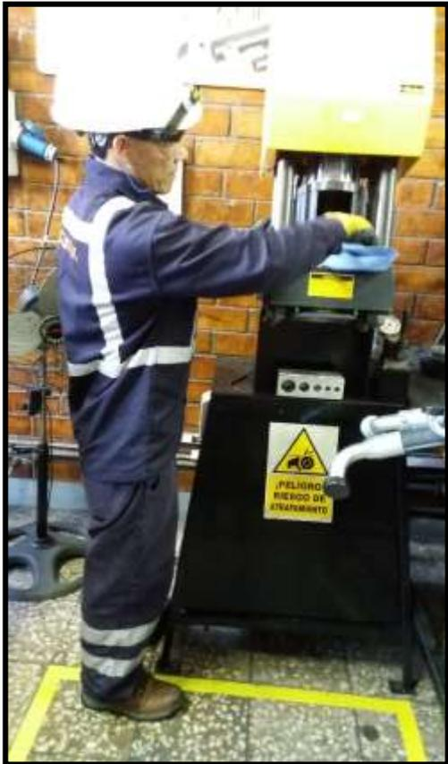
Limpiando la máquina ensambladora con un Wypall (trapo industrial).
