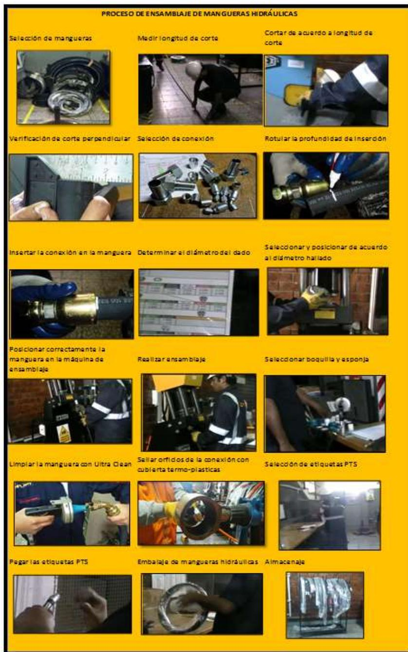
**Figura N° 01: Proceso de ensamblaje de mangueras hidráulicas**
