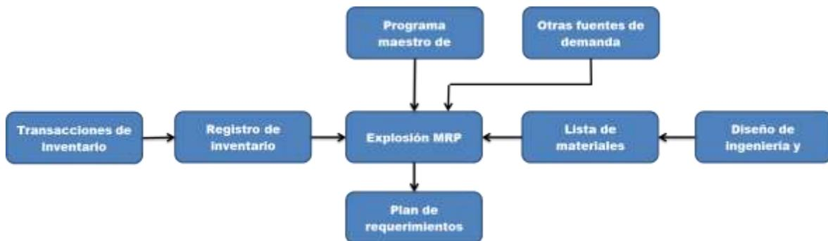
Figura 2.2 : Datos de entrada para el plan de requerimientos de materiales
