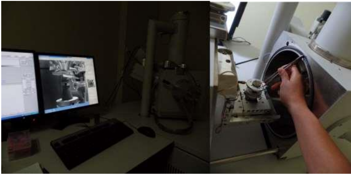
Fig. 20 A la izquierda, el Microscopio Electrónico de Barrido. A la derecha, la colocación de una muestra de girogonites para ser barridos.
