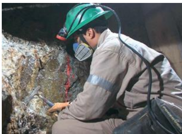
Figura 13 Inspección de vetas
