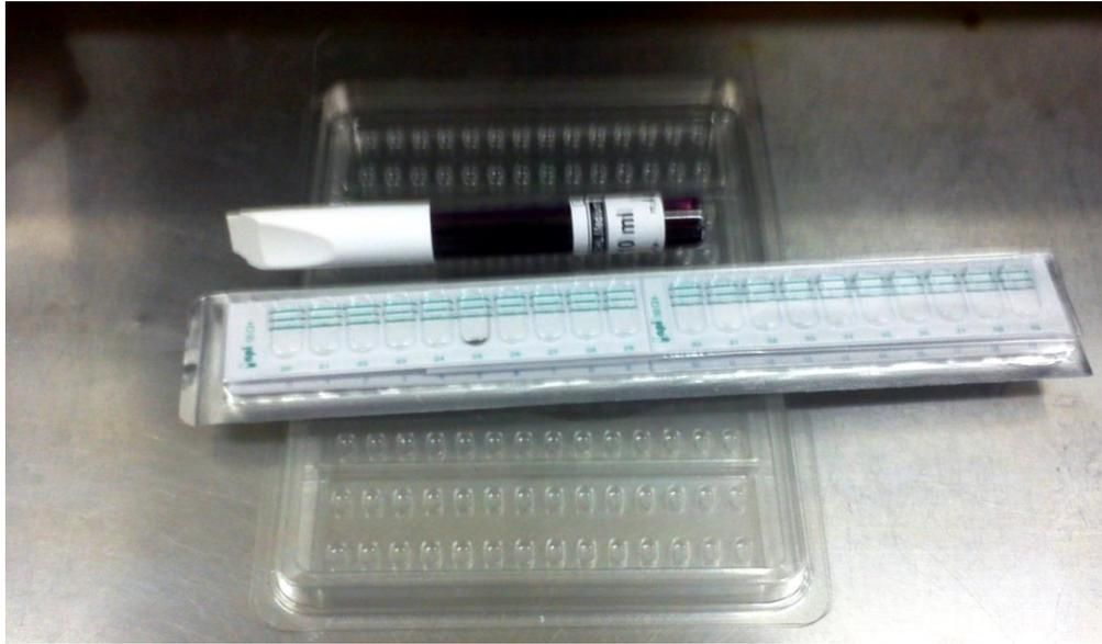
**Fig. N° 9:** Kit api 50CH– BIOMÉRIEUX y api 50CH Medium, para la identificación Bioquímica de las Bacterias Lácticas (BAL)
